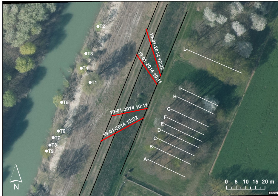
Figura 63 - Ricostruzione della relazione geometrica tra la posizione delle aperture delle tane degli animali selvatici – così come apparivano nelle foto aeree del 29-03-2012 – e lo sviluppo della breccia arginale alle ore 10:11 (Figura 64) e 12:22 del giorno 19-01-2014 (Figura 65).
