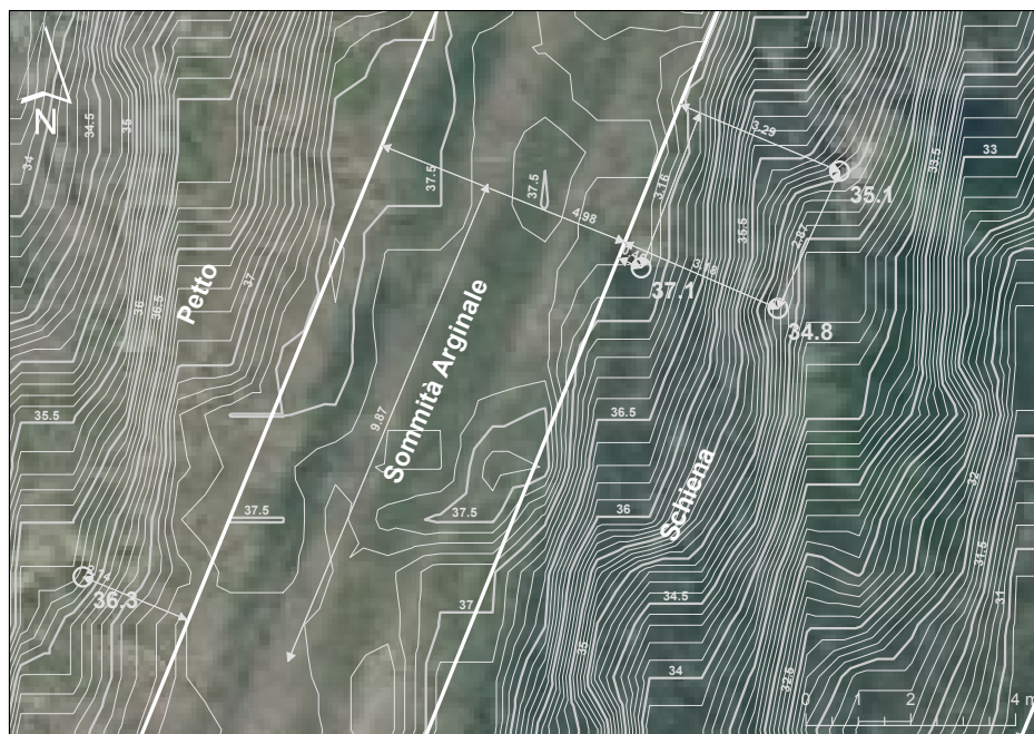
Figura 70 - Ricostruzione della posizione planimetrica ed altimetrica delle aperture sull'argine dovute alle tane degli animali selvatici.
