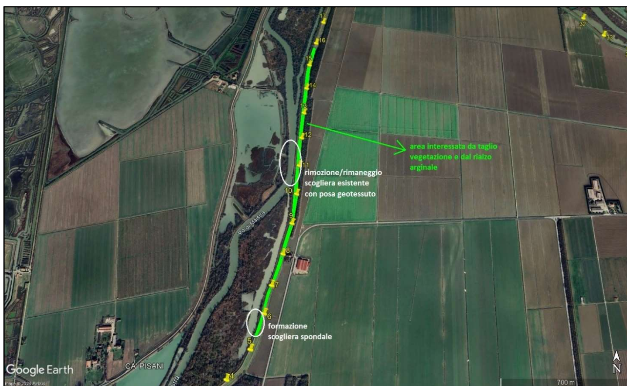
Figura 36 - Individuazione dell'estensione complessiva (circa 2080 m) dell'area del rialzo arginale in progetto (verde) con evidenziazione dei settori interessati dalla formazione (a monte dello st. 6) o dal rimaneggio (nell'intorno dello st. 11) di parti di scogliera.
