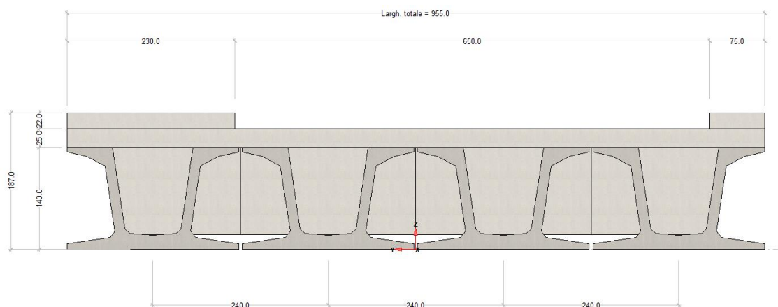
Sezione trasversale impalcato
