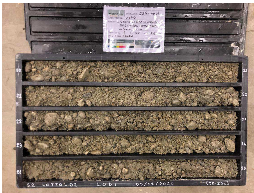
Figura 14 - Sondaggio S2, profondità 20,00-25,00m.
