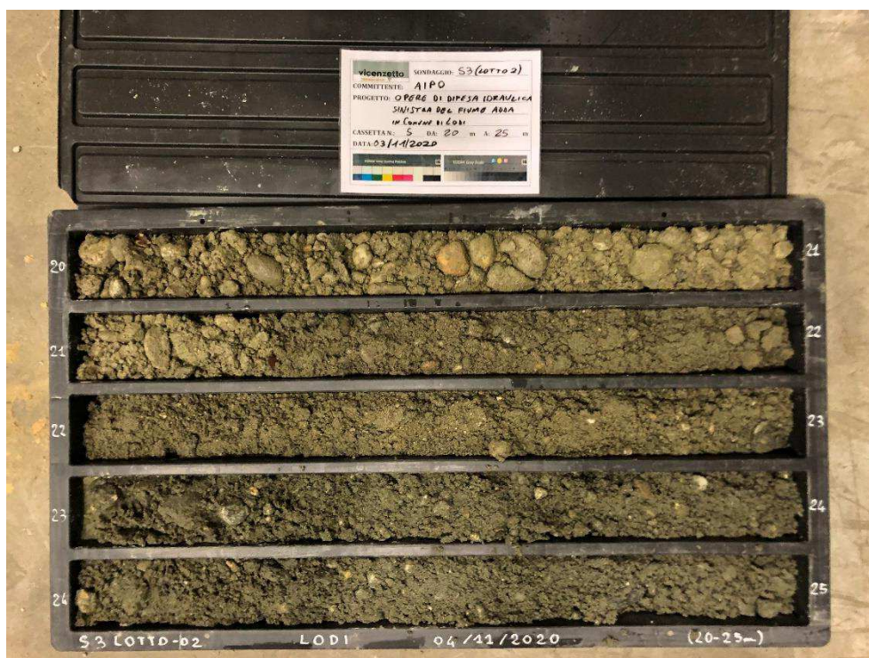
Figura 22 - Sondaggio S3, profondità 20,00-25,00m.
