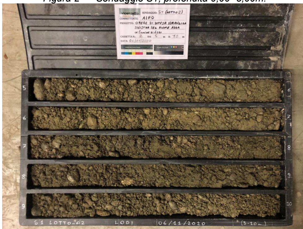
Figura 3 - Sondaggio S1, profondità 5,00-10,00m.
