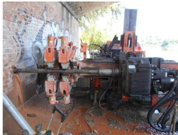
Fig. 4.4: Esecuzione sondaggi a carotaggio continuo orizzontali
