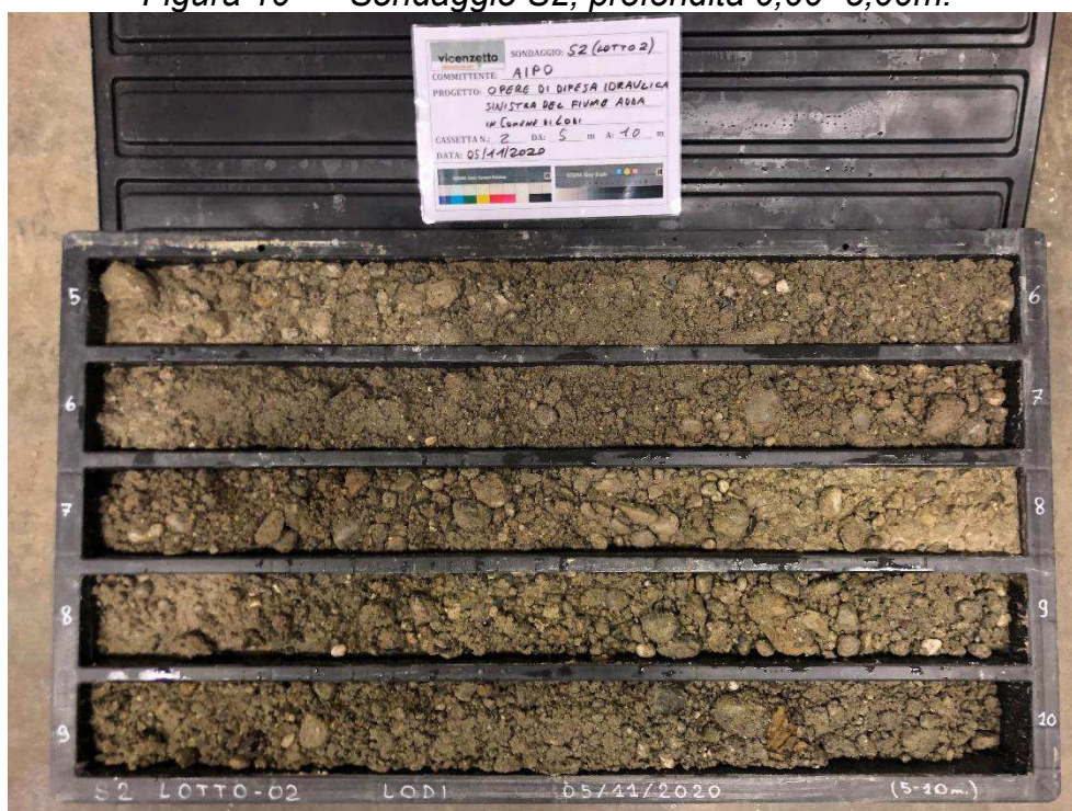
Figura 11 - Sondaggio S2, profondità 5,00-10,00m.
