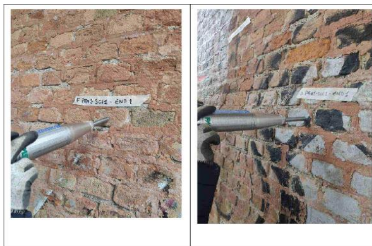
Fig. 4.9: Prove sclerometriche su mattoni
