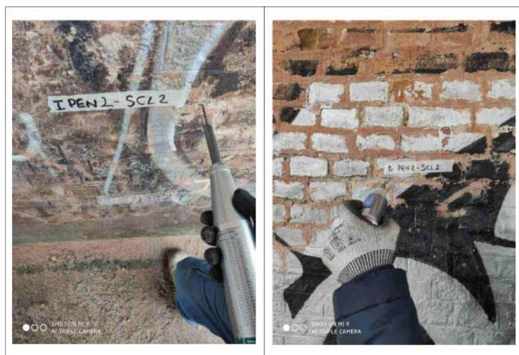
Fig. 4.8: Prove penetrometriche su malta
