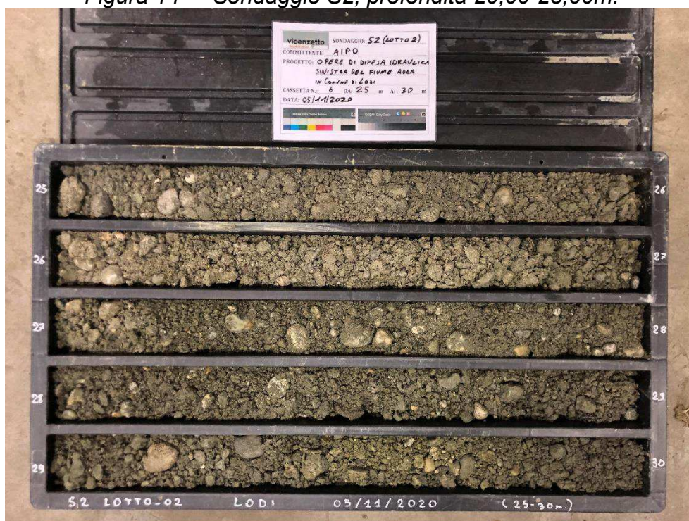
Figura 15 - Sondaggio S2, profondità 25,00-30,00m.
