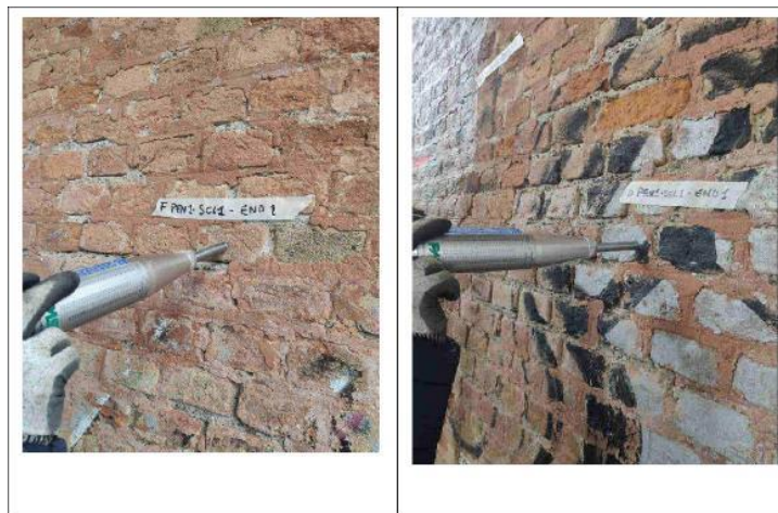
Fig. 4.9 – Prove sclerometriche su mattoni
