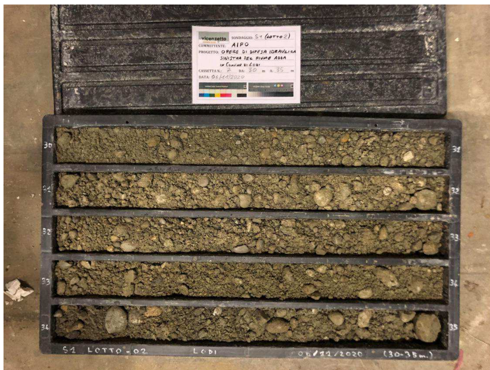
Figura 8 - Sondaggio S1, profondità 30,00-35,00m.
