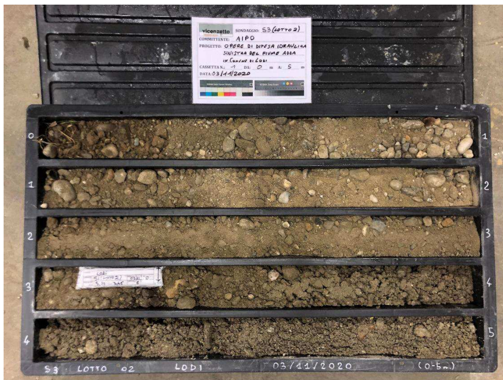
Figura 18 – Sondaggio S3, profondità 0,00 -5,00m.
