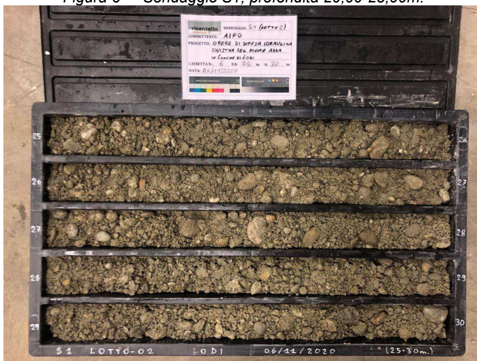
Figura 7 - Sondaggio S1, profondità 25,00-30,00m.
