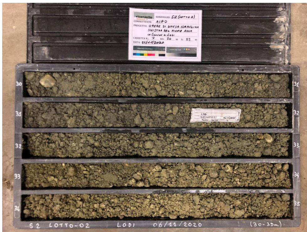
Figura 16 - Sondaggio S2, profondità 30,00-35,00m.
