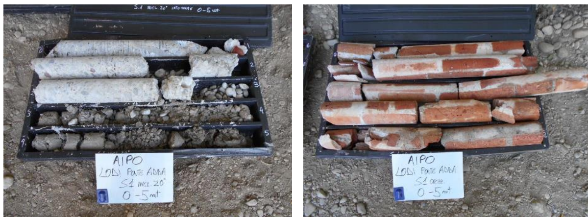
Fig. 4.5 – Carote di materiale estratte durante i sondaggi
