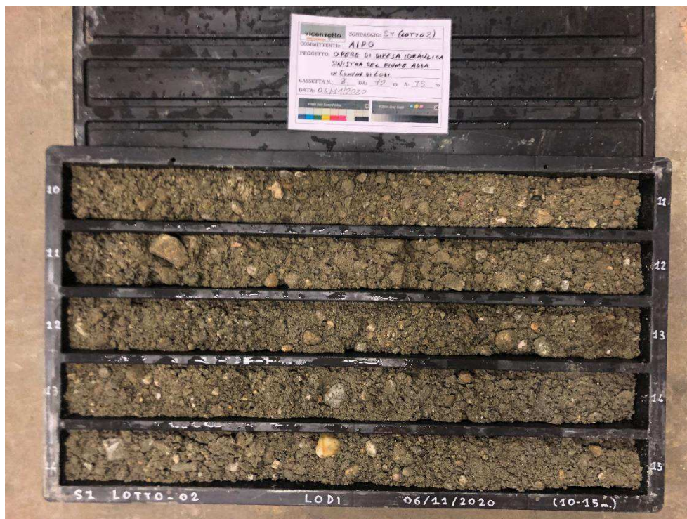
Figura 4 - Sondaggio S1, profondità 10,00-15,00m.
