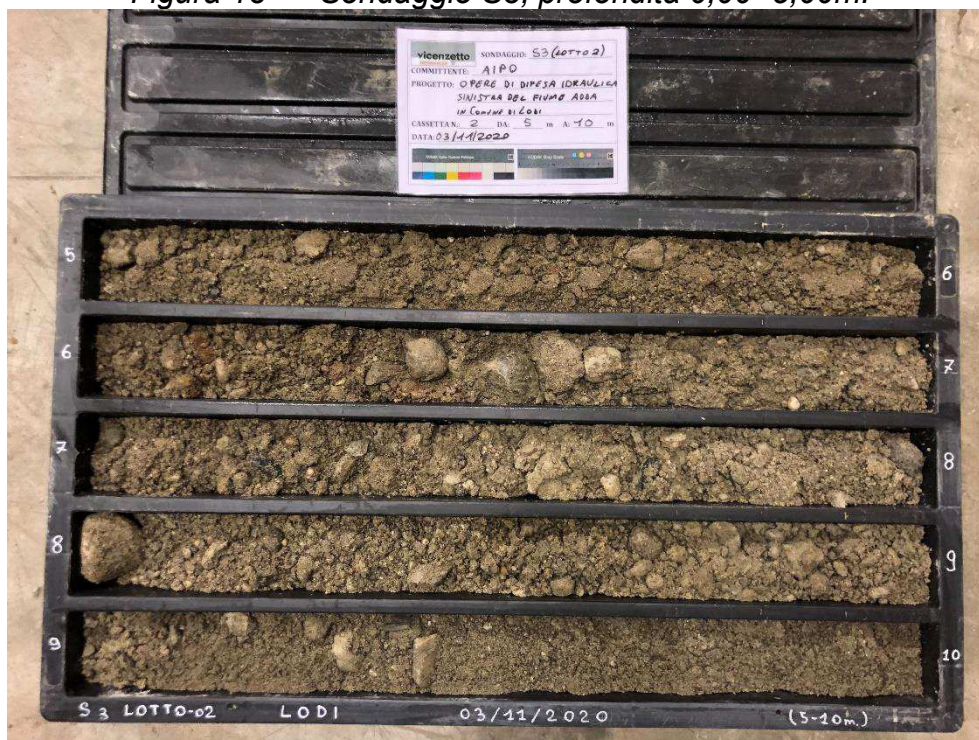
Figura 19 - Sondaggio S3, profondità 5,00-10,00m.
