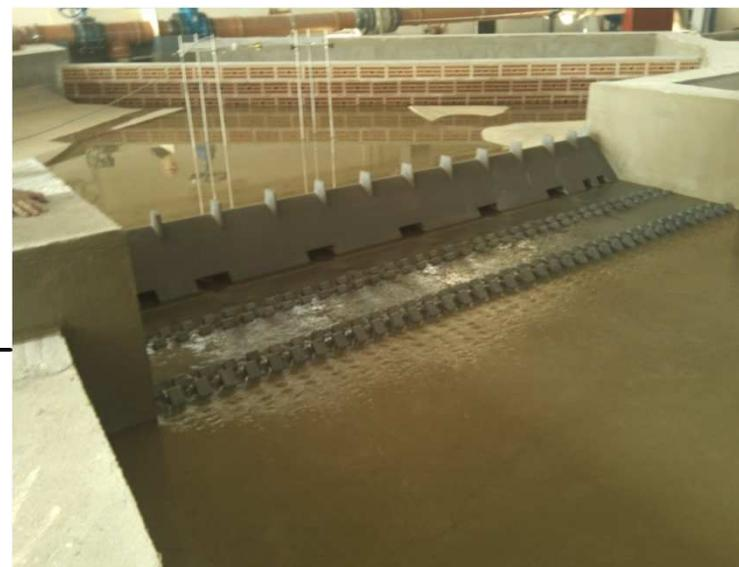
Traversa di regolazione della cassa sul Panaro – modello fisico – Laboratorio AIPo di Boretto
