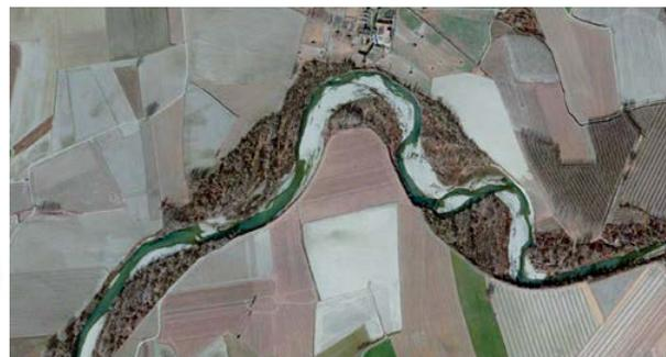
Lotto 5 - Intervento 9 - marzo 2022 ante operam, da cui si apprezza la finalità principale dell'intervento ovvero allontanare la corrente dalla sponda sinistra in erosione in prossimità della cascina e della frazione di loc. Bruciacuore; post operam - febbraio 2024 (rilievo con il drone), comprensivo degli interventi in varianti resi necessari a seguito della piena di maggio 2023 avvenuta mentre i lavori erano in corso.
