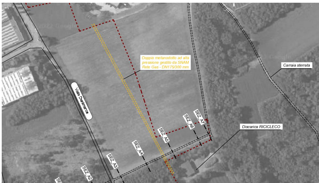
FIGURA 3-3 INTERFERENZA CON IL METANODOTTO GESTITO DA SNAM SPA NEL TRATTO SETTENTRIONALE DELL'INTERVENTO TRA LE SEZIONI A4 ED A5
