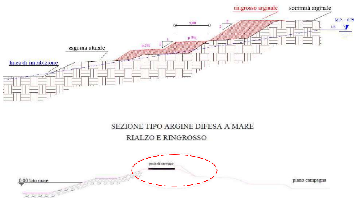
Figura 17. Sezione tipo argine fluviale, esempio 1. Ringrossi senza nuova occupazione arginale
