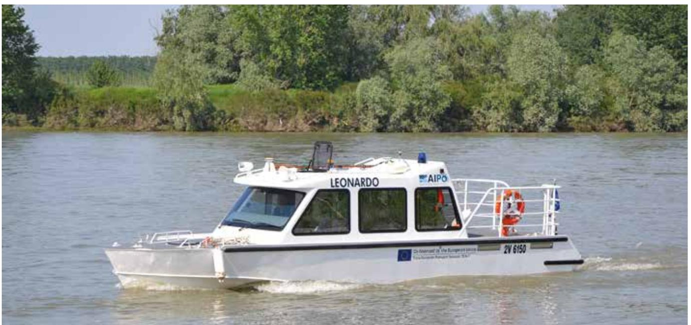
"Leonardo", l'imbarcazione equipaggiata con sistema acustico tipo multibeam, utilizzata principalmente per il rilievo e il monitoraggio del canale navigabile e la conseguente generazione del modello 3D dei fondali (DTM).
