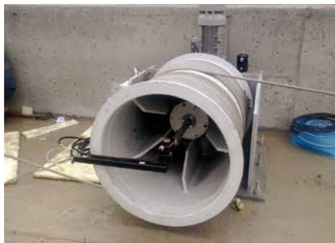
Figura 21 - particolare del sistema di movimentazione delle paratoie
