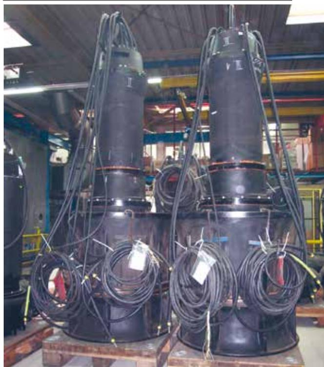
Figura 20 - due delle sei elettropompe sommergibili
