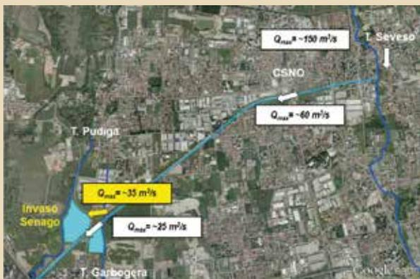
Figura 9 – Schema funzionale del CSNO in corrispondenza dell'area di laminazione di Senago.
