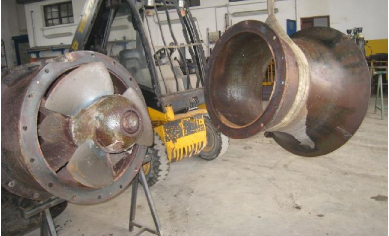
Figura 1 – Elicopompe e campana aspirante smontata per eseguire la manutenzione.
