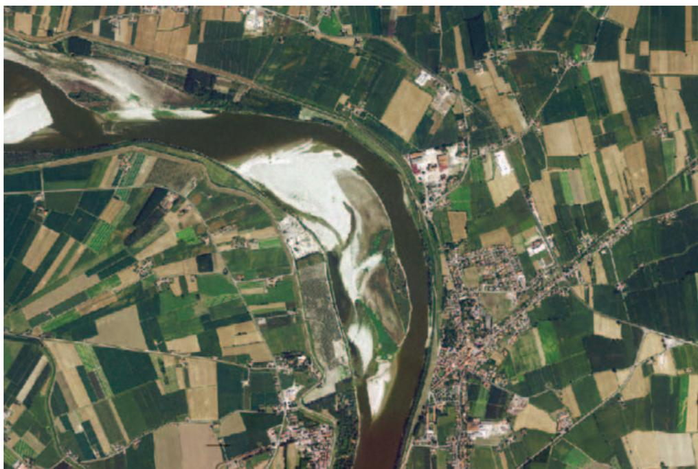
Figura 2. Ortoimmagine dell'ansa di Ficarolo acquisita nel 2007. L'abitato di Ficarolo in sinistra idrografica (a destra nell'immagine) risulta direttamente investito dal filone principale della corrente. In destra idrografica sono emersi estesi e rilevanti depositi che hanno interamente ostruito il ramo principale del fiume Po ora fortemente concentrato in sinistra idraulica.
