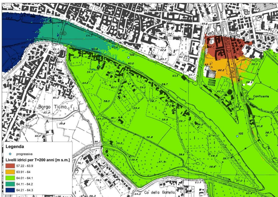
Figura 19 – risultati del modello 2D – stato attuale - piena con T=200 anni: livelli idrici
