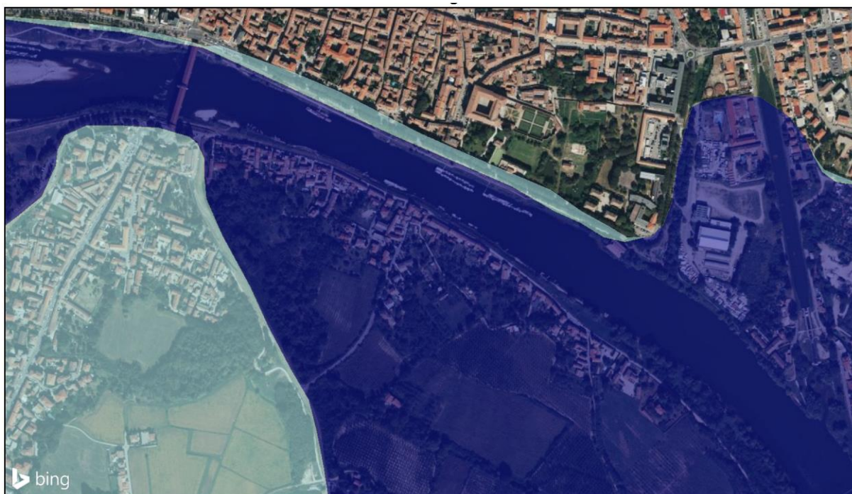
Figura 6 – carta della pericolosità da alluvione del PGRA del F. Ticino nei pressi di Pavia (blu: pericolosità frequente; azzurro scuro: pericolosità poco frequente; azzurro chiaro: pericolosità rara)
