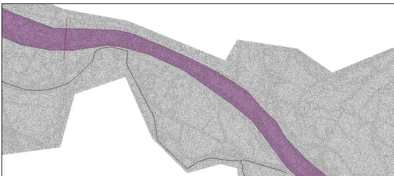
Figura 15 – dettaglio della magliatura di calcolo del modello bidimensionale del fiume Ticino nei pressi del tratto di intervento all'interno del Comune di Pavia
