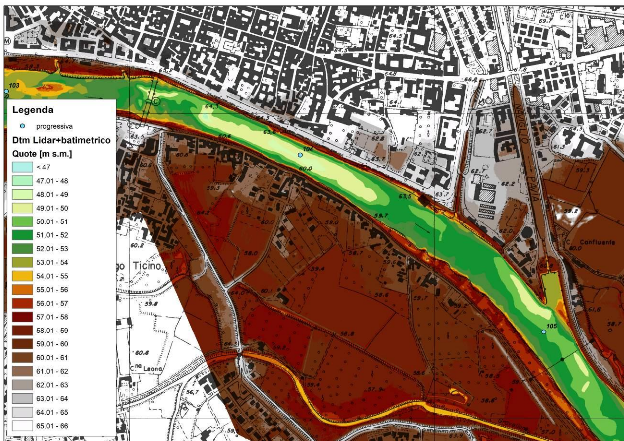
Figura 13 – D.T.M. fiume Ticino da rilievo Lidar e rilievo batimetrico
