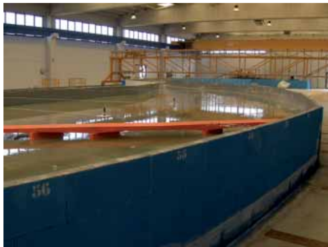
Modello idraulico a fondo mobile del fiume Tanaro ad Alessandria
