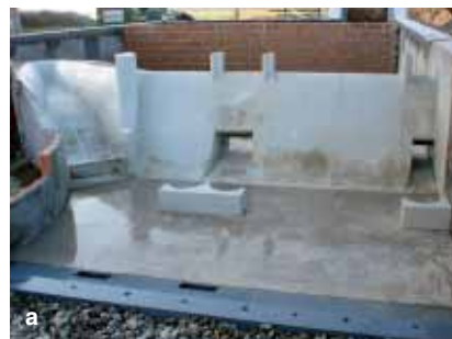
Figura 5 - a) primo modello idraulico della cassa di espansione sul Torrente Parma (2004); b) nuovo modello del 2008-sezione del traliccio in acciaio inox contenente la strumentazione nelle piastre di fondo.
