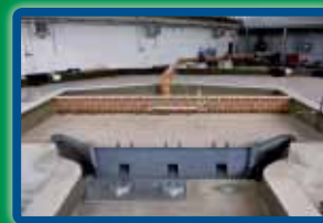
Visuale d'insieme del Laboratorio di Idraulica n. 1: in primo piano il modello fisico del manufatto regolatore della Cassa di espansione sul Torinese Parma (2008).
