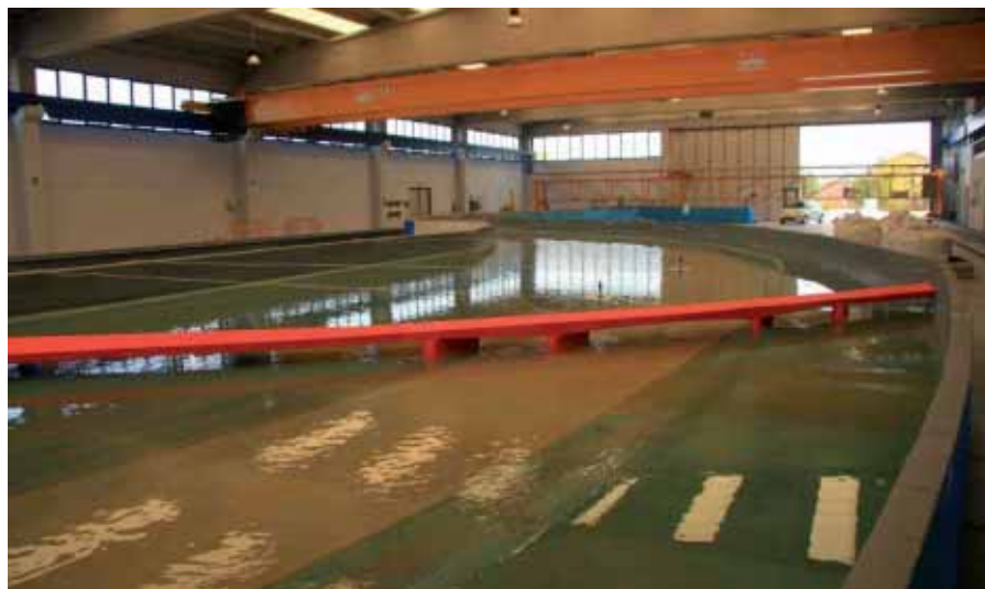
Figura 7 - Vista da valle verso monte del modello fisico del Fiume Tanaro.
