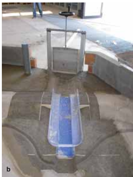
Figura 6 - Modello idraulico della cassa di espansione sui Torrenti Chisola e Rio Torto; a) veduta d'insieme; b) modello del manufatto regolatore in plexiglas.
