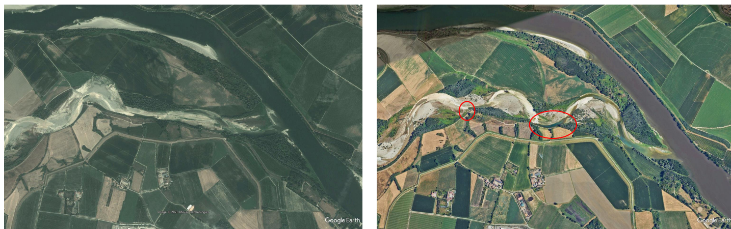
Figura 3 – confronto immagine satellitare 2012 (a sinistra) – 2023 (a destra). In rosso sono evidenziati i tratti di sponda in erosione oggetto di interventi di sistemazione idraulica.
