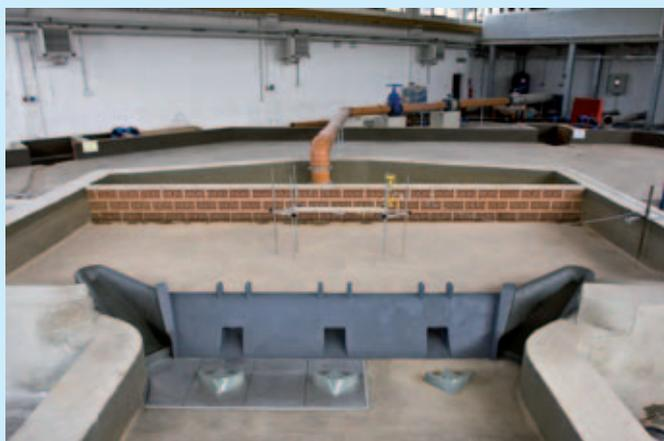
Modello fisico del manufatto regolatore della Cassa di espansione sul T. Parma (realizzato all'interno del Laboratorio n.1)
