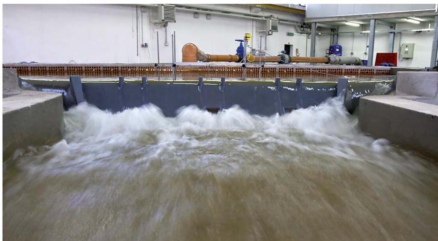
Figura 6 - Portata millenaria evacuata dalle luci di fondo e dallo sfioratore di superficie
