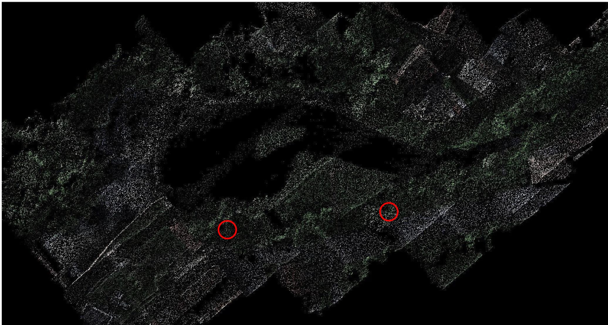
Vista del rilievo a valle della centralina idroelettrica, visibili nei cerchi in rosso i MARKER rilevati anche con GPS
