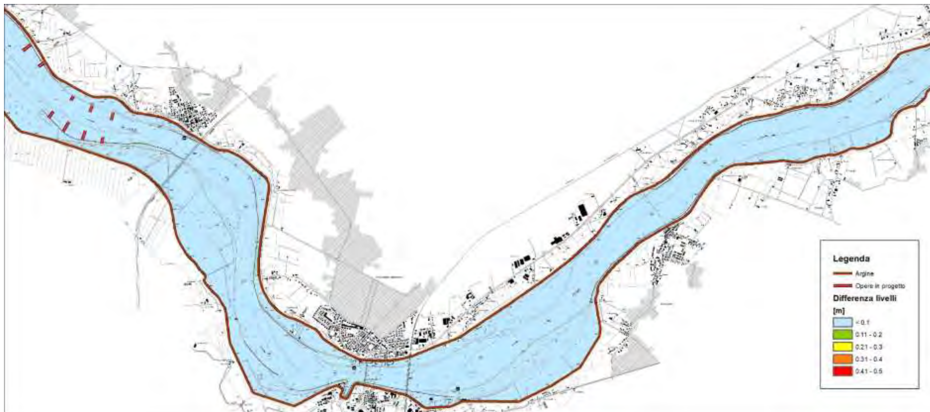
Figura 130 – risultati modello idraulico bidimensionale a fondo fisso – differenza tra assetto di progetto e stato attuale – piena PAI – livelli idrici – 4 di 4 (scala 1:50'000)
