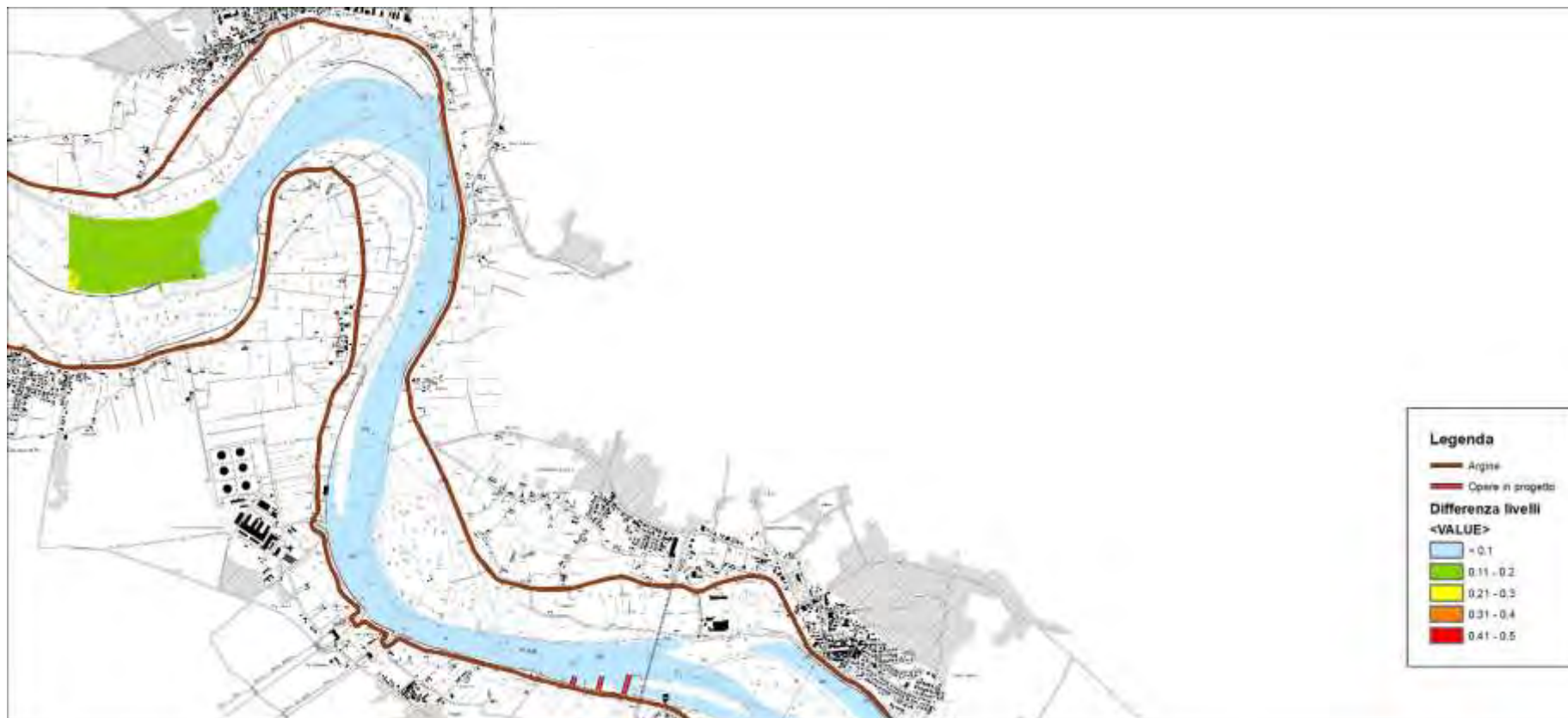
Figura 163 – risultati modello idraulico bidimensionale a fondo fisso – differenza tra assetto di progetto e stato attuale – portata magra – livello idrico – 1 di 4 (scala 1:50'000)
