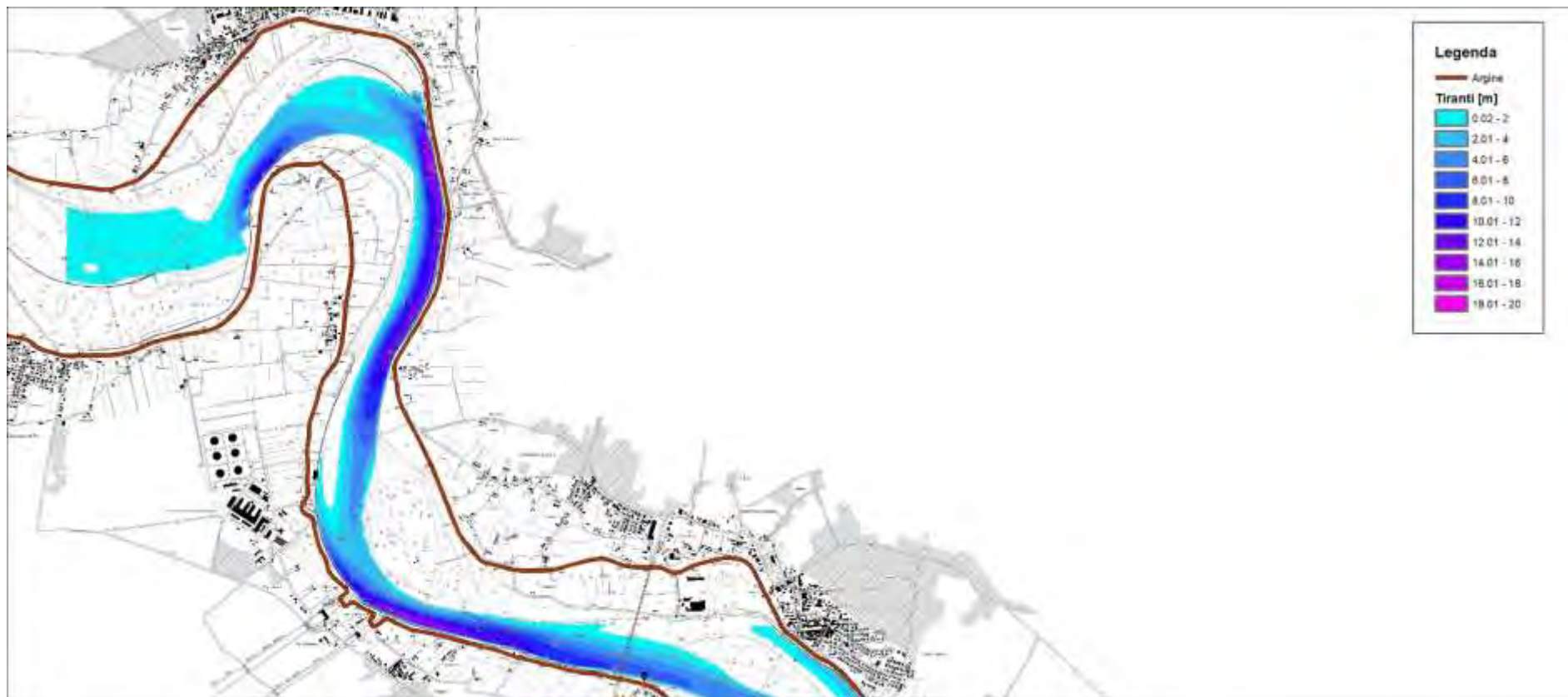
Figura 59 – risultati modello idraulico bidimensionale a fondo fisso – stato attuale – portata in secca – tirante idrico – 1 di 4 (scala 1:50'000)
