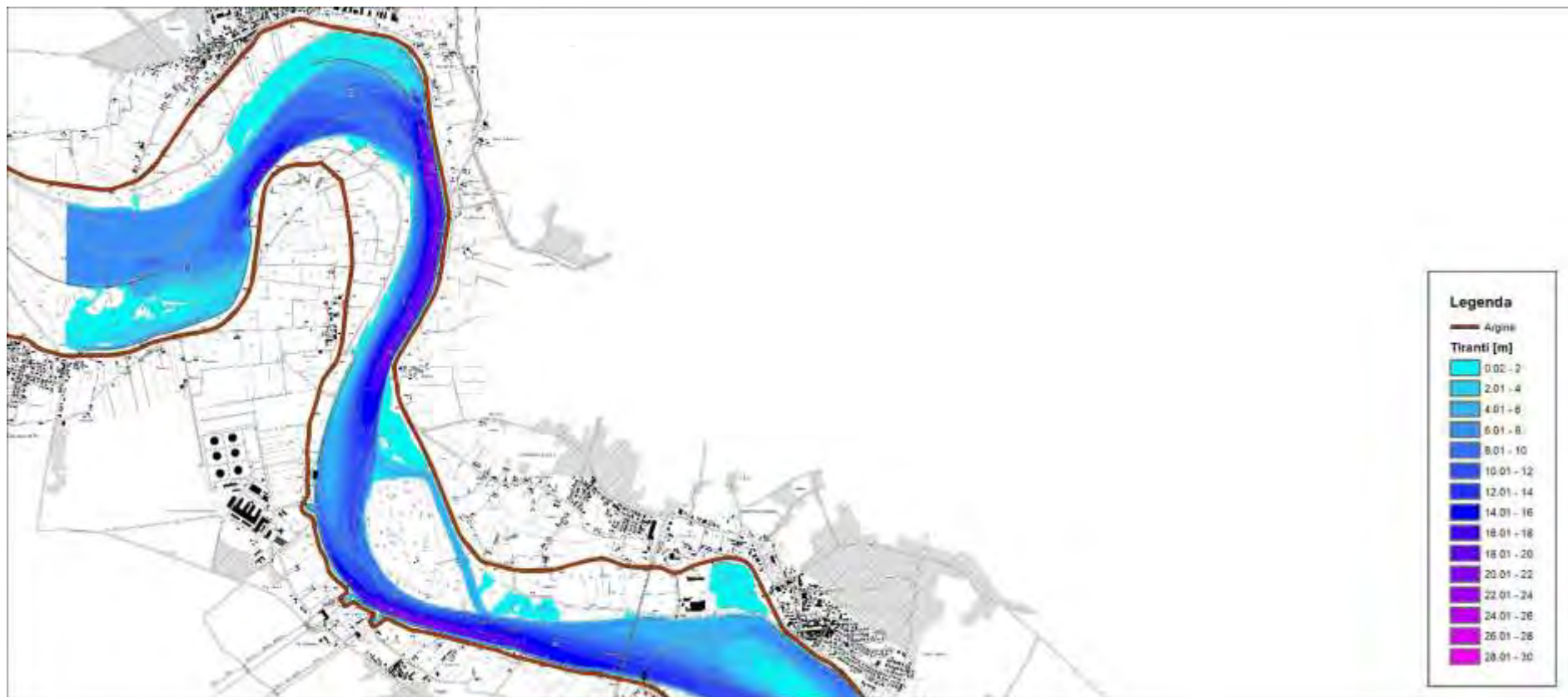
Figura 23 – risultati modello idraulico bidimensionale a fondo fisso – stato attuale – piena ordinaria – tiranti idrici – 1 di 4 (scala 1:50'000)
