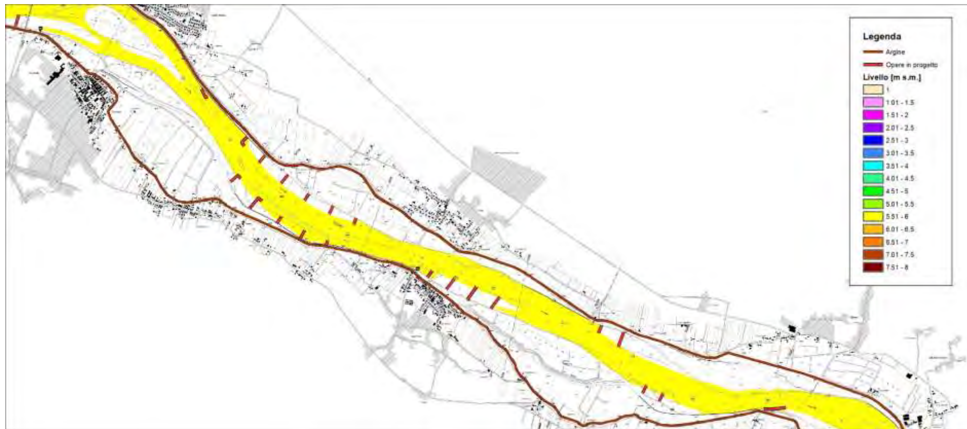
Figura 116 – risultati modello idraulico bidimensionale a fondo fisso – assetto di progetto – portata in secca – livello idrico – 2 di 4 (scala 1:50'000)
