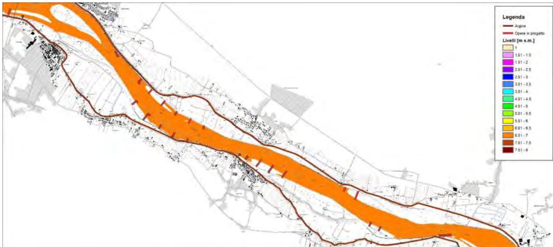
Figura 104 – risultati modello idraulico bidimensionale a fondo fisso – assetto di progetto – portata magra – livello idrico – 2 di 4 (scala 1:50'000)
