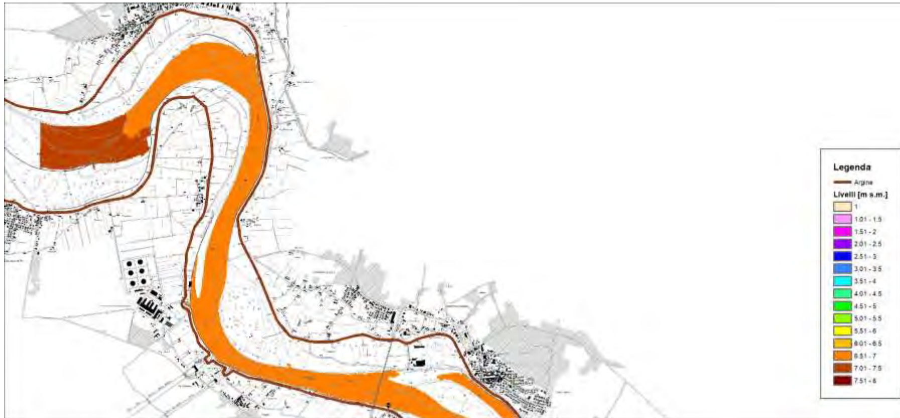
Figura 43 – risultati modello idraulico bidimensionale a fondo fisso – stato attuale – portata magra – livello idrico – 1 di 4 (scala 1:50'000)
