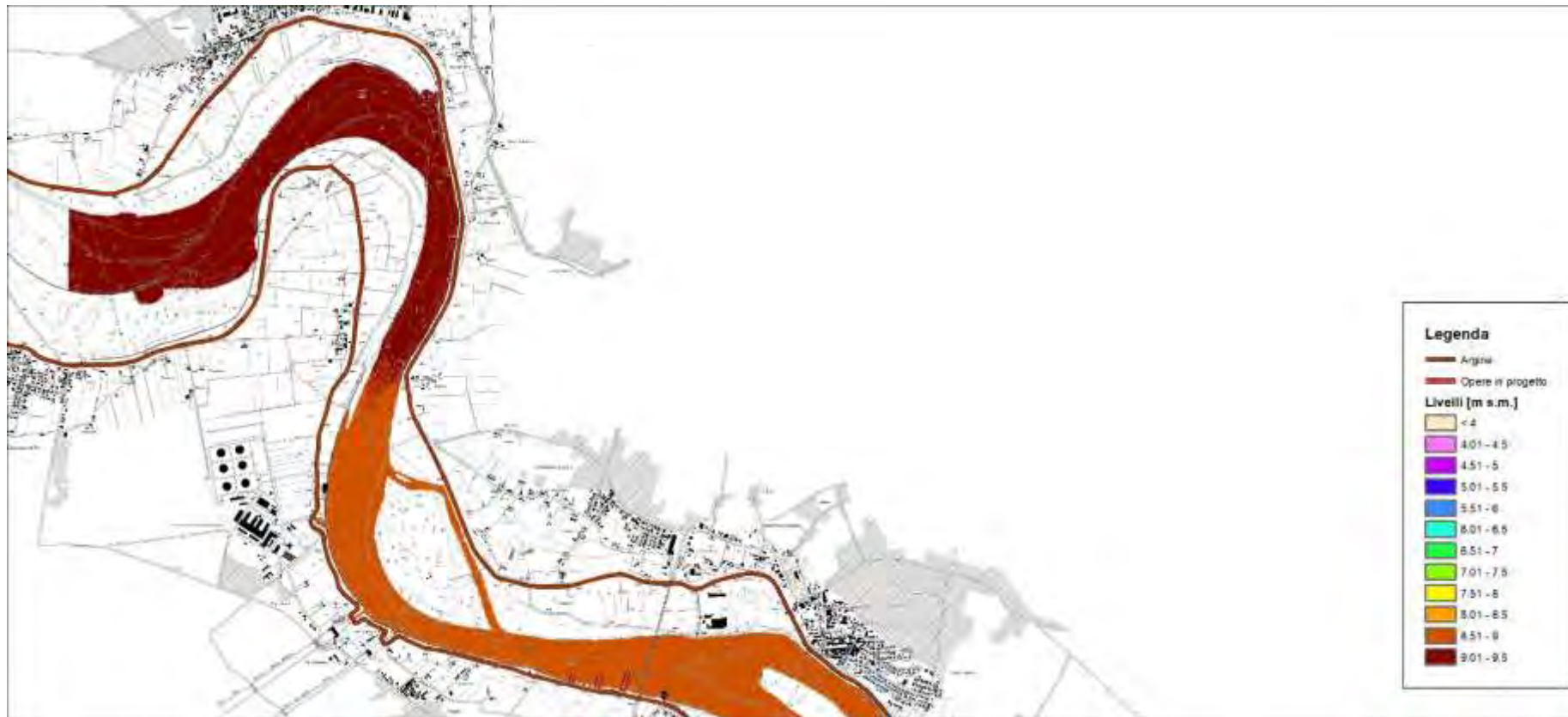
Figura 91 – risultati modello idraulico bidimensionale a fondo fisso – assetto progetto – portata media annua – livelli idrici – 1 di 4 (scala 1:50'000)
