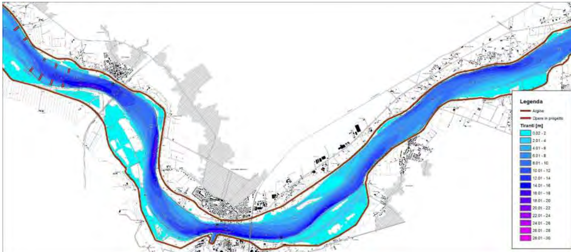
Figura 86 – risultati modello idraulico bidimensionale a fondo fisso – assetto progetto – piena ordinaria – tiranti idrici – 4 di 4 (scala 1:50'000)
