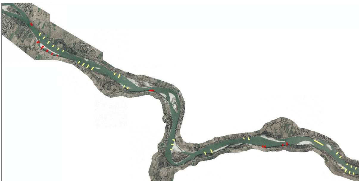
Figura 32 – In rosso: opere selezionate come primo stralcio delle opere complessive individuate nel presente progetto. In giallo le opere di stralci successivi.
