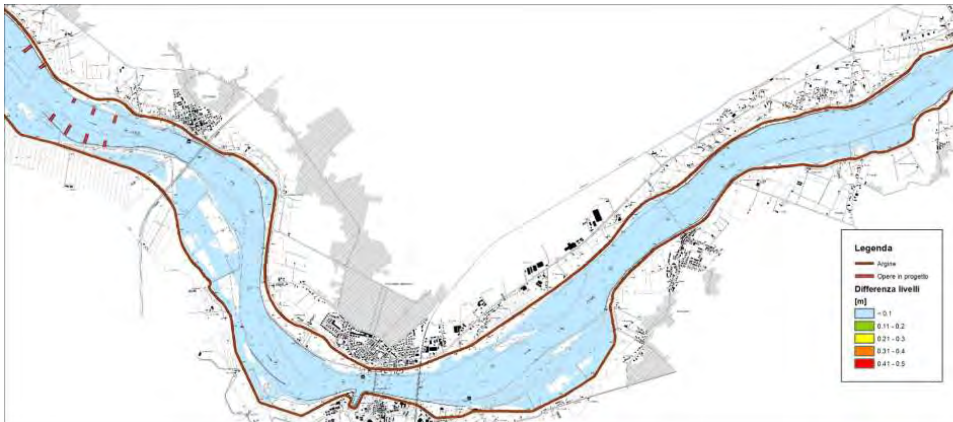
Figura 142 – risultati modello idraulico bidimensionale a fondo fisso – differenza tra assetto di progetto e stato attuale – piena ordinaria – livello idrico – 4 di 4 (scala 1:50'000)
