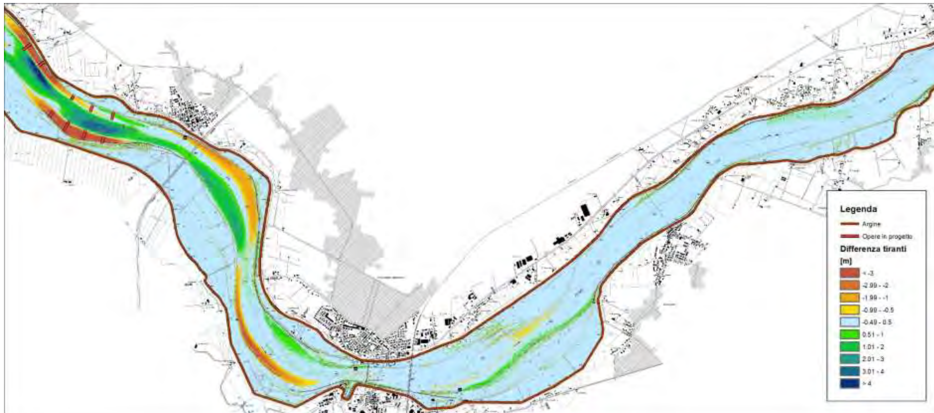
Figura 134 – risultati modello idraulico bidimensionale a fondo fisso – differenza tra assetto di progetto e stato attuale – piena PAI – tirante idrico – 4 di 4 (scala 1:50'000)
