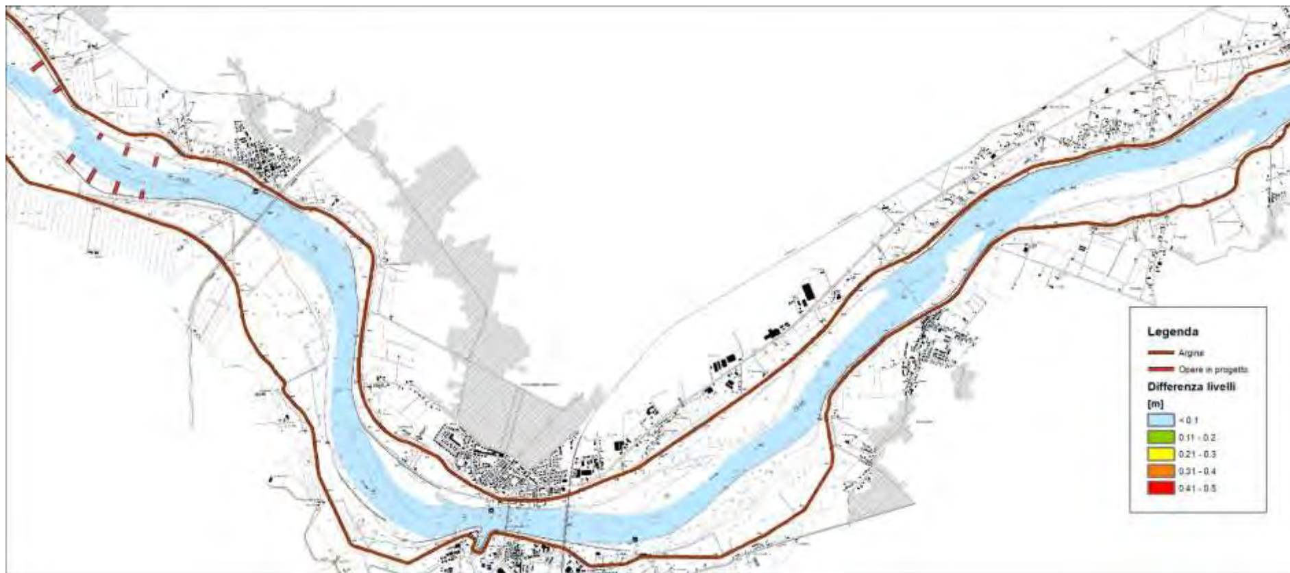
Figura 178 – risultati modello idraulico bidimensionale a fondo fisso – differenza tra assetto di progetto e stato attuale – portata in secca – livello idrico – 4 di 4 (scala 1:50'000)
