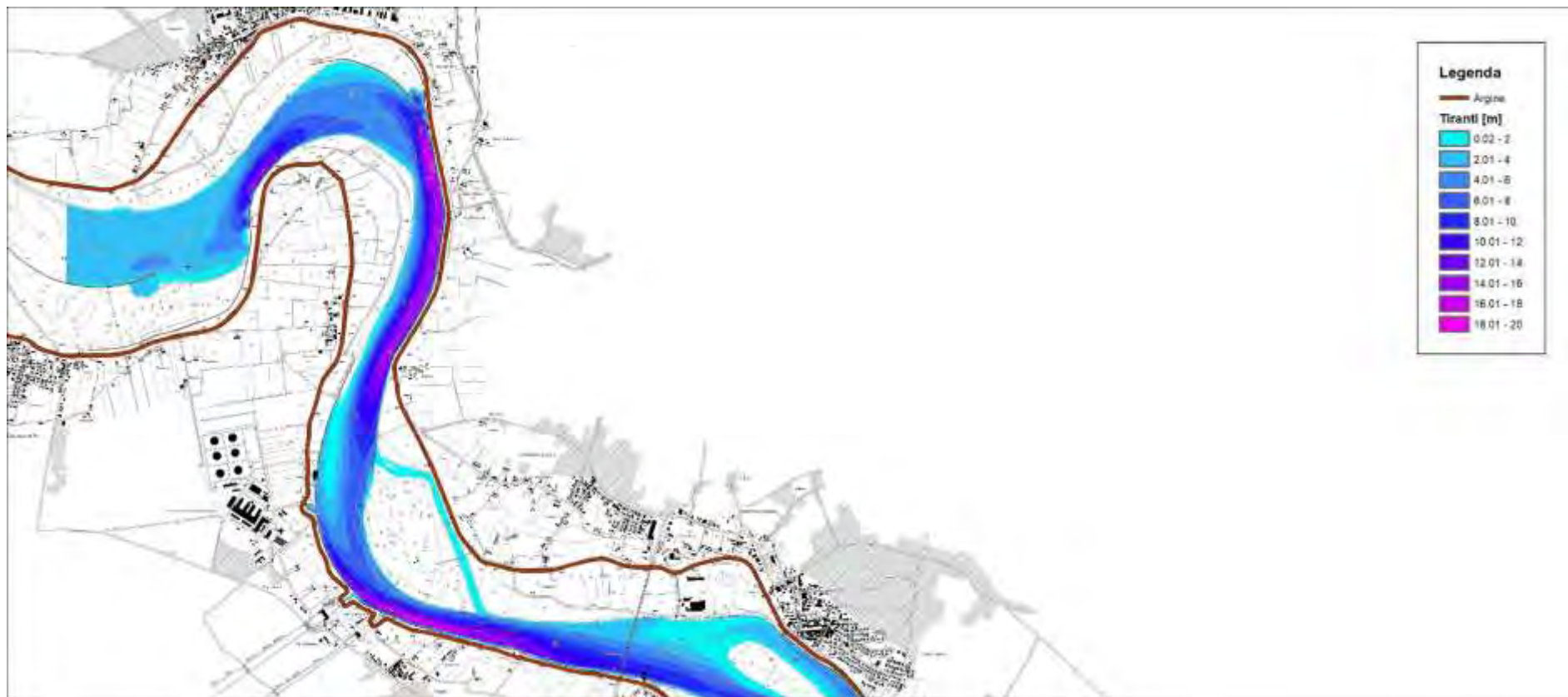
Figura 35 – risultati modello idraulico bidimensionale a fondo fisso – stato attuale – portata media annua – tiranti idrici – 1 di 4 (scala 1:50'000)
