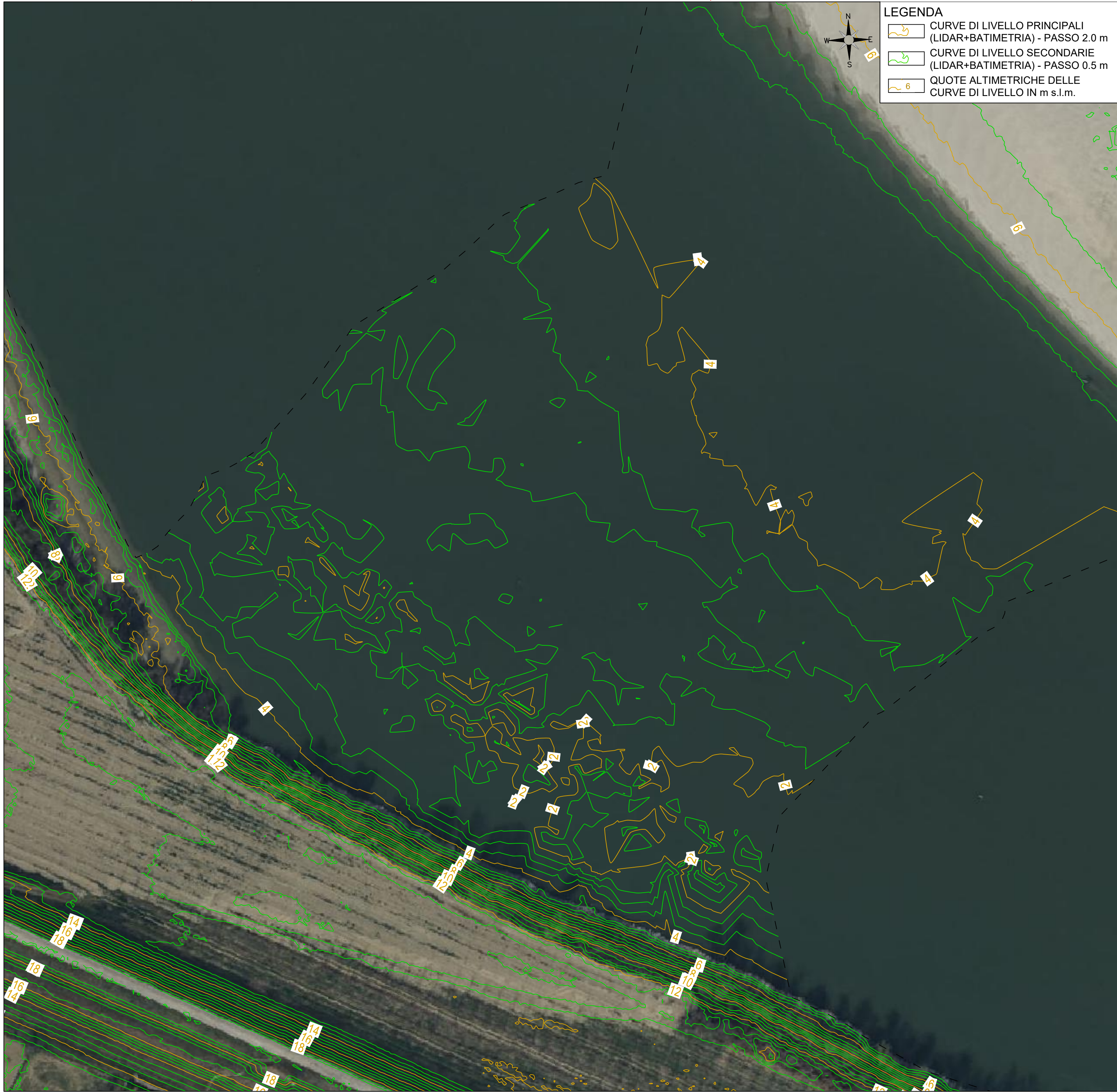
MODELLO DEL TERRENO (INTERPOLAZIONE DEL RILIEVO LIDAR2022 E DEL RILIEVO BATIMETRICO) - SCALA 1:1.000
