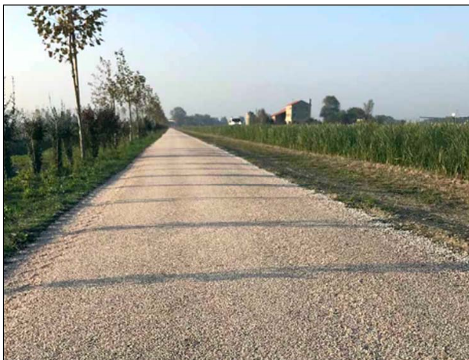
Figura 8 – Effetto realizzativo della pavimentazione in depolverizzato a tre strati in colorazione chiara
