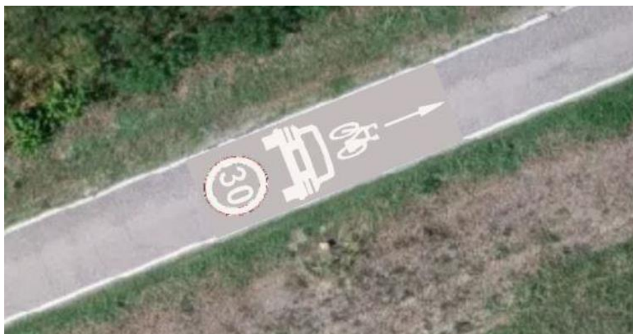
Figura 13: Segnaletica per tratto in promiscuo con la viabilità veicolare - Dimensione della plancia di verniciatura: 50x200 cm
