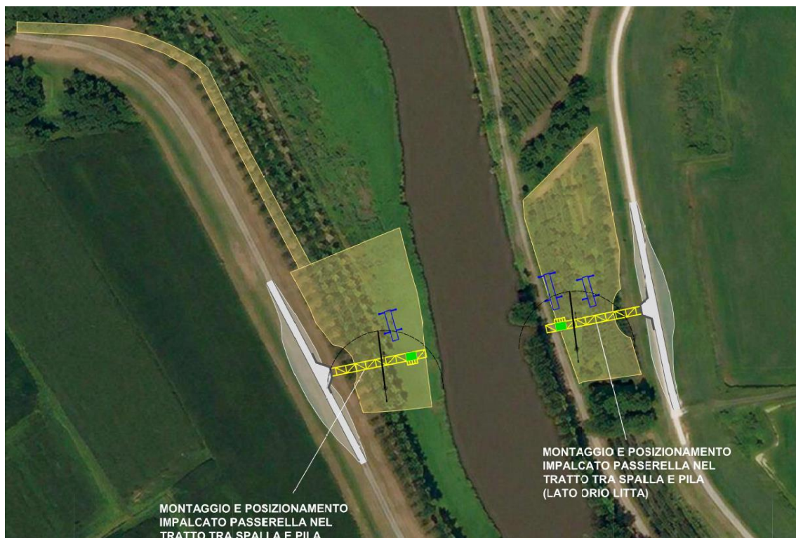
Figura 155: Ponte Lambrinia – montaggio blocco 1 (lato Lambrinia e lato Orio Litta).
