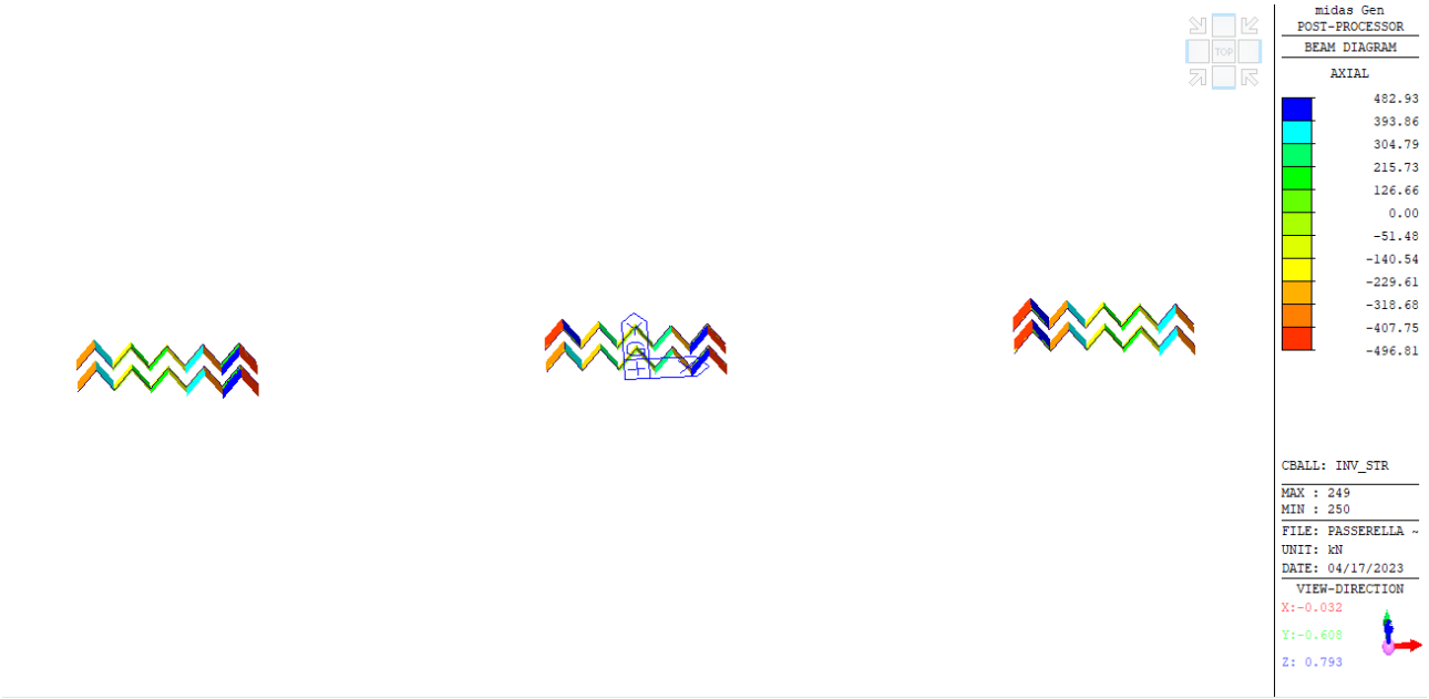
Figura 70: Azione assiale controventi – HEB200
