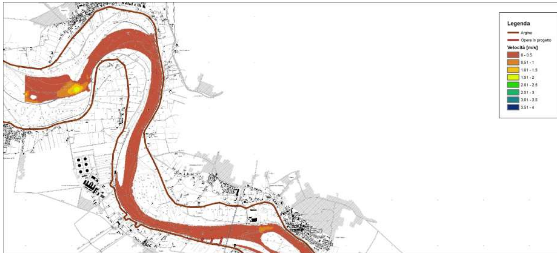
Figura 123 – risultati modello idraulico bidimensionale a fondo fisso – assetto di progetto – portata in secca – velocità della corrente – 1 di 4 (scala 1:50'000)
