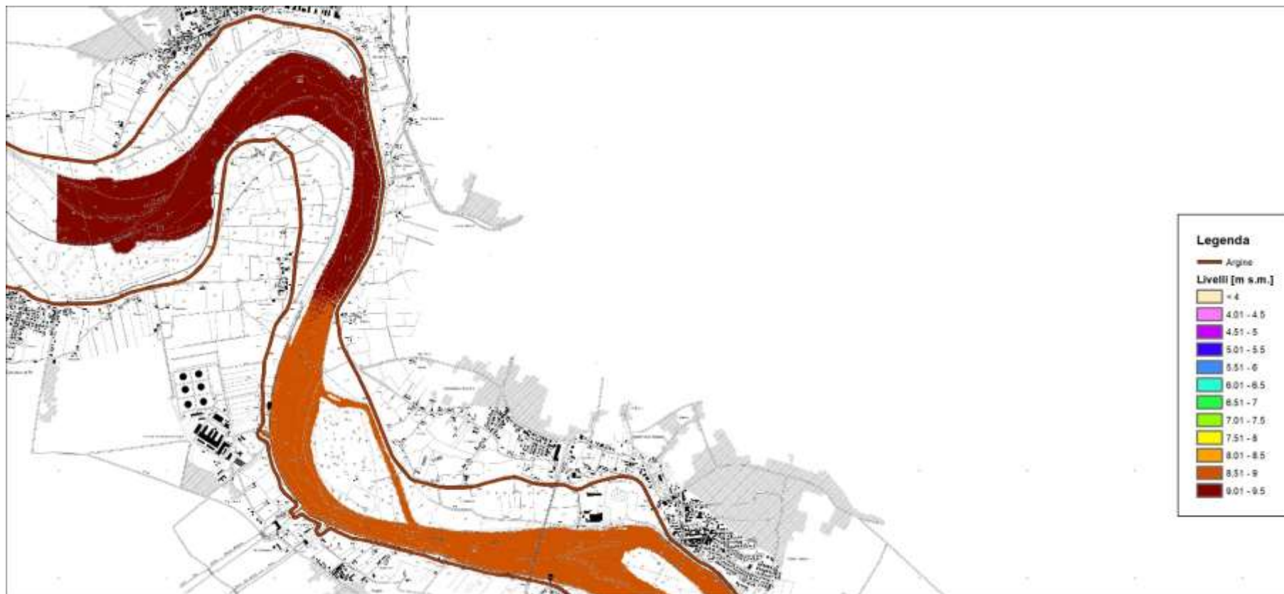
Figura 31 – risultati modello idraulico bidimensionale a fondo fisso – stato attuale – portata media annua – livelli idrici – 1 di 4 (scala 1:50'000)
