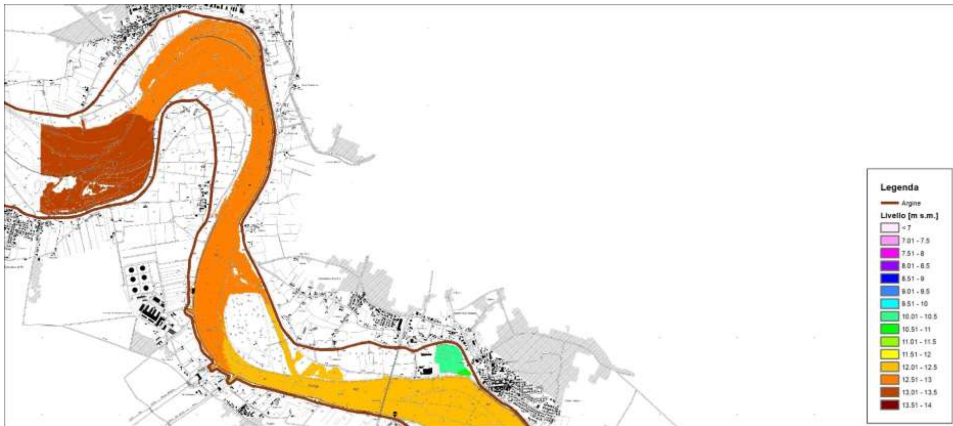
Figura 19 – risultati modello idraulico bidimensionale a fondo fisso – stato attuale – piena ordinaria – livelli idrici – 1 di 4 (scala 1:50'000)
