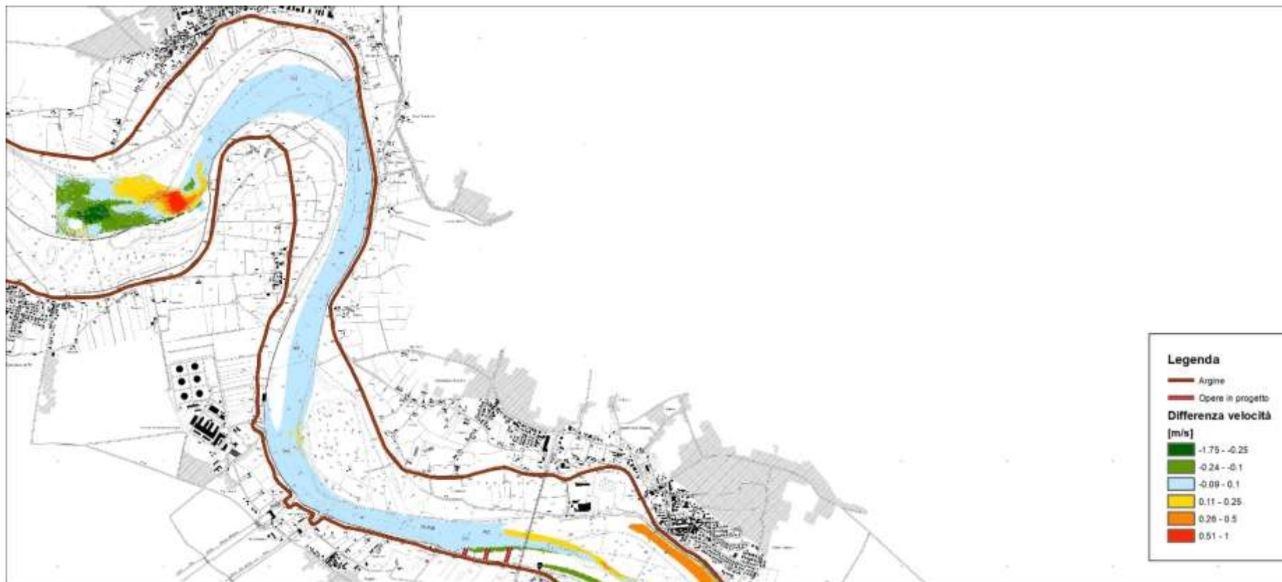
Figura 183 – risultati modello idraulico bidimensionale a fondo fisso – differenza tra assetto di progetto e stato attuale – portata in secca – velocità della corrente – 1 di 4 (scala 1:50'000)
