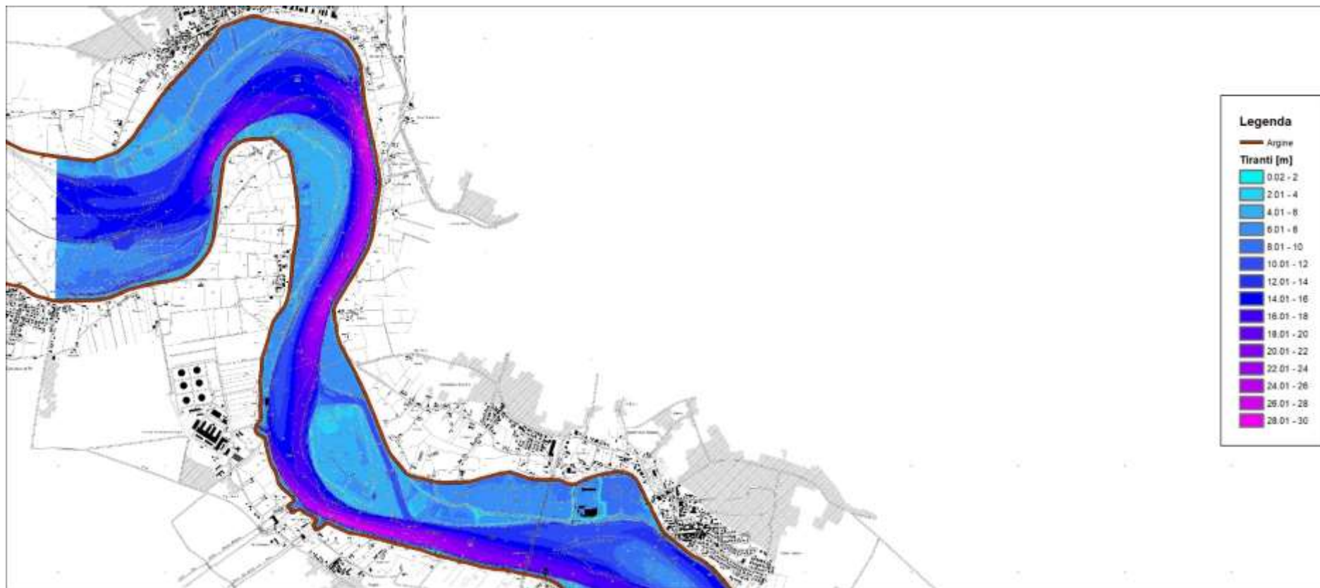
Figura 11 – risultati modello idraulico bidimensionale a fondo fisso – stato attuale – piena PAI – tiranti idrici – 1 di 4 (scala 1:50'000)
