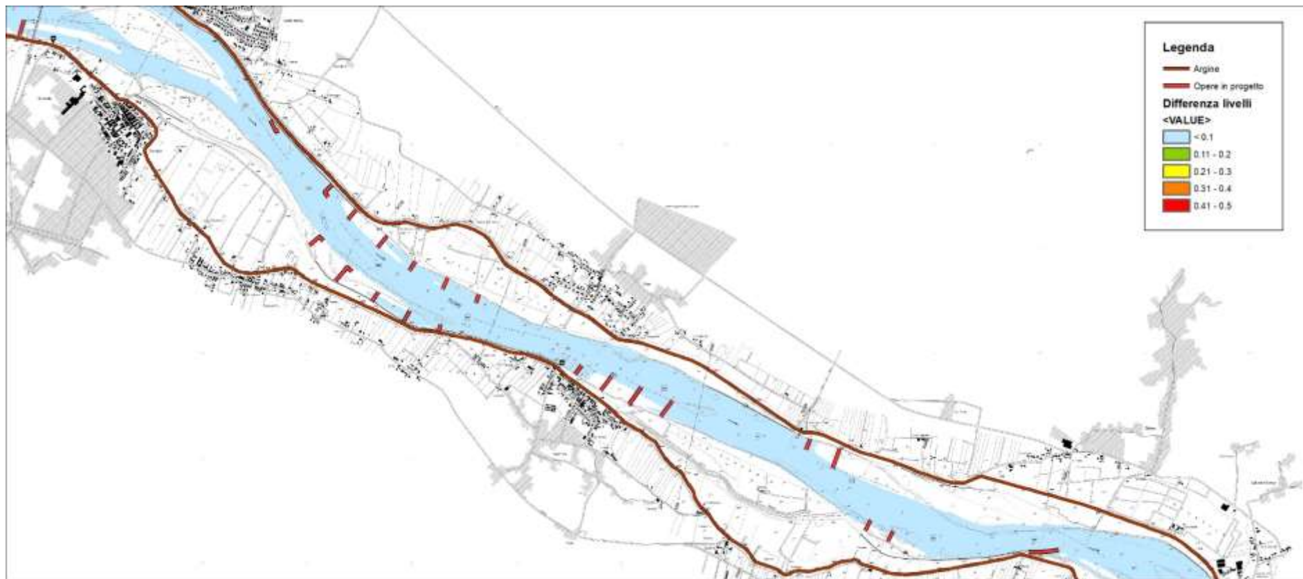
Figura 164 – risultati modello idraulico bidimensionale a fondo fisso – differenza tra assetto di progetto e stato attuale – portata magra – livello idrico – 2 di 4 (scala 1:50'000)
