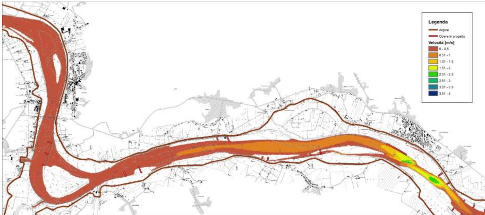
Figura 113 – risultati modello idraulico bidimensionale a fondo fisso – assetto di progetto – portata magra – velocità della corrente – 3 di 4 (scala 1:50'000)
