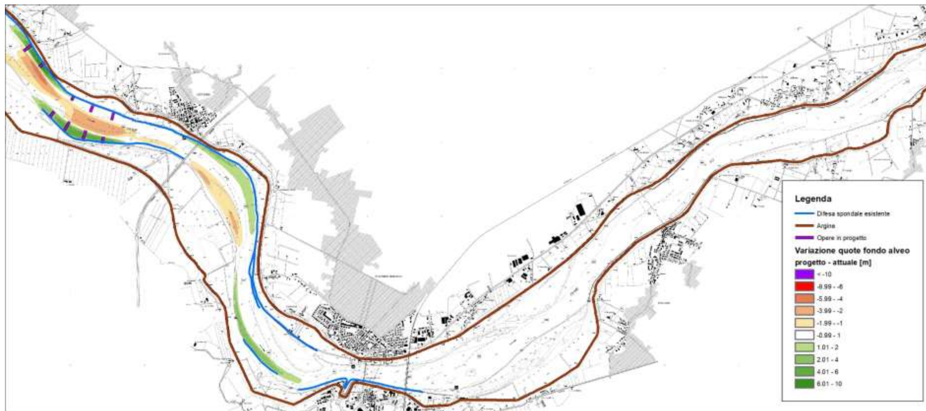
Figura 189 – differenza quote alveo inciso tra assetto di progetto e stato attuale, dopo 10 anni di simulazione con modello a fondo fisso (periodo 2005 – 2015) – 3 di 4 (scala 1:50'000)
