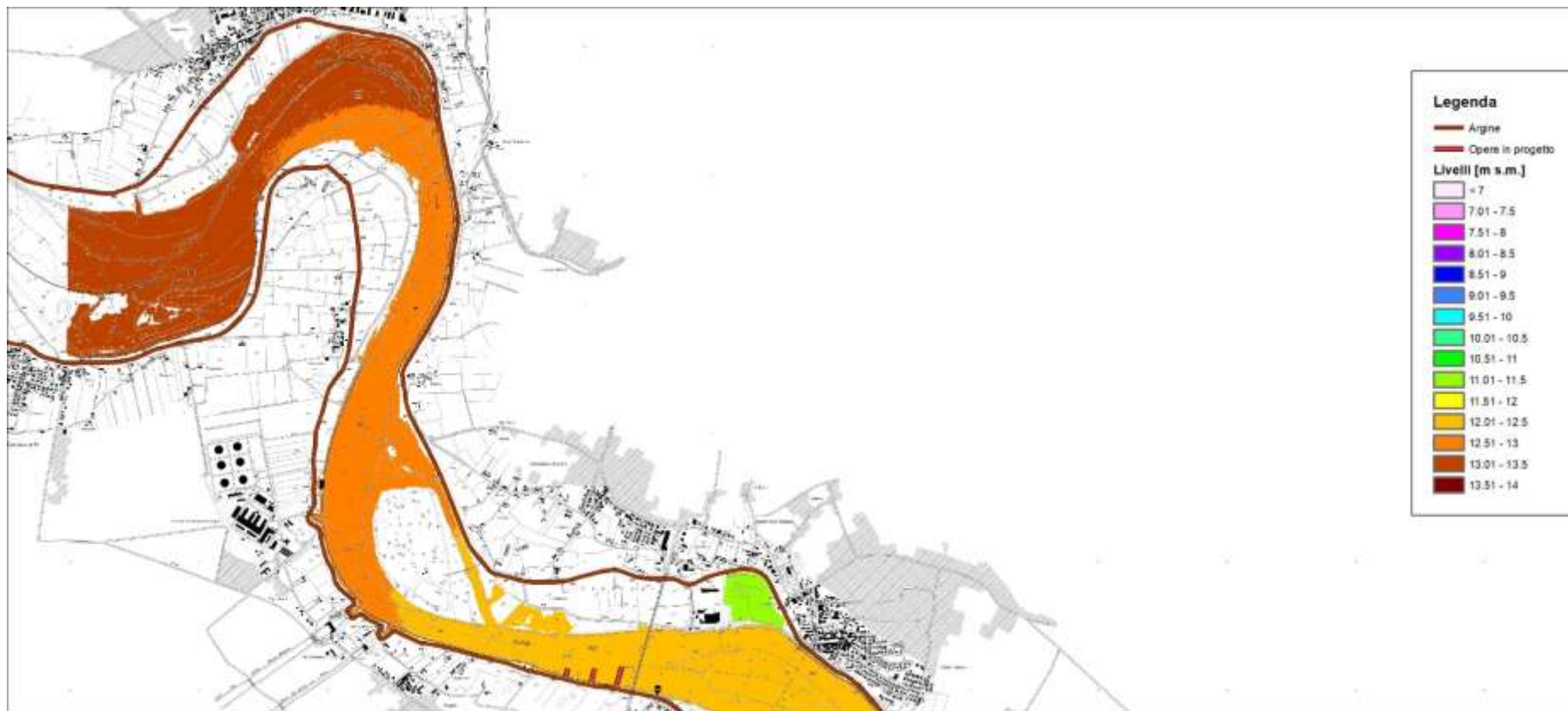
Figura 79 – risultati modello idraulico bidimensionale a fondo fisso – assetto progetto – piena ordinaria – livelli idrici – 1 di 4 (scala 1:50'000)
