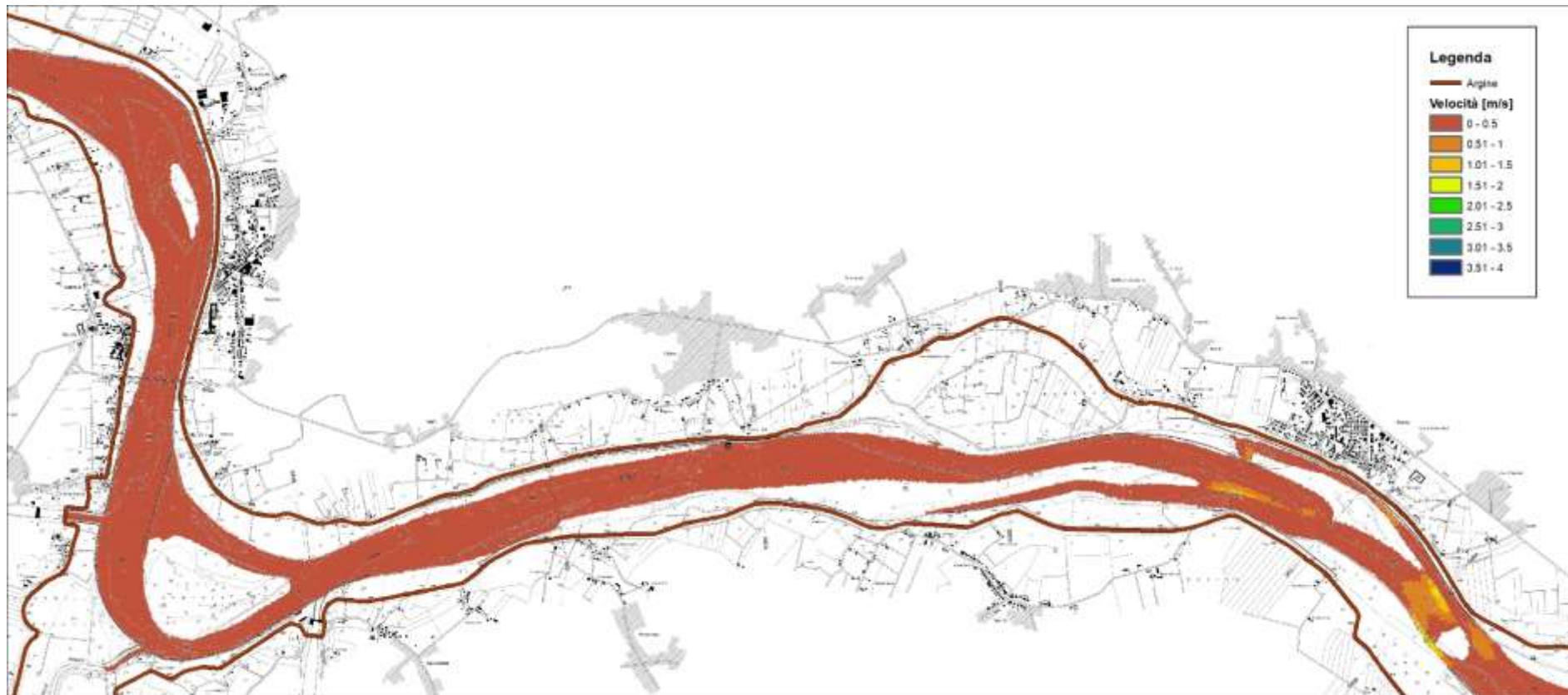
Figura 65 – risultati modello idraulico bidimensionale a fondo fisso – stato attuale – portata in secca – velocità della corrente – 3 di 4 (scala 1:50'000)
