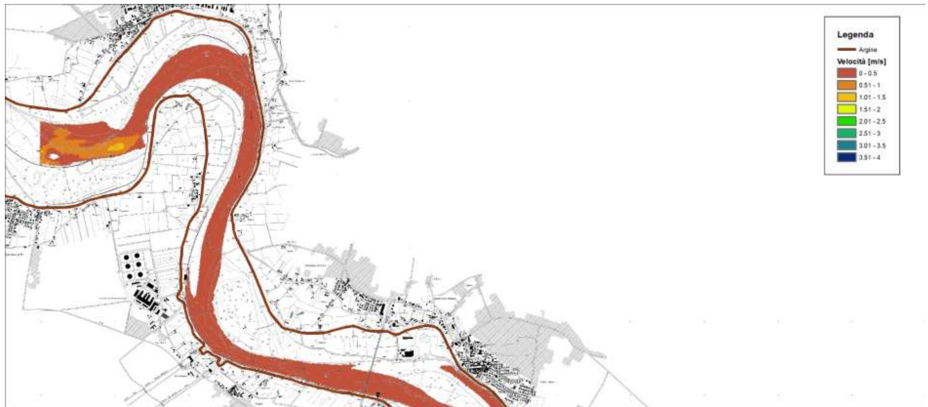
Figura 63 – risultati modello idraulico bidimensionale a fondo fisso – stato attuale – portata in secca – velocità della corrente – 1 di 4 (scala 1:50'000)
