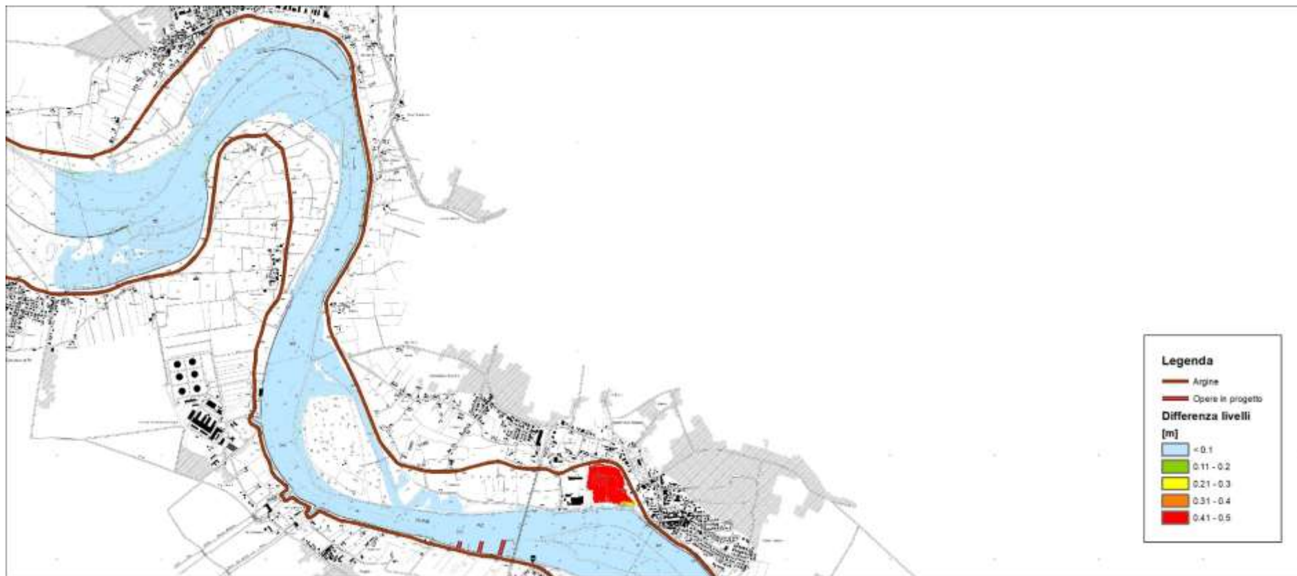
Figura 139 – risultati modello idraulico bidimensionale a fondo fisso – differenza tra assetto di progetto e stato attuale – piena ordinaria – livello idrico – 1 di 4 (scala 1:50'000)
