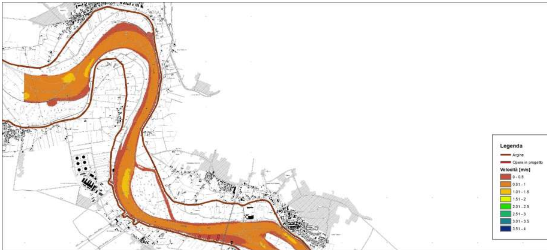
Figura 99 – risultati modello idraulico bidimensionale a fondo fisso – assetto progetto – portata media annua – velocità della corrente – 1 di 4 (scala 1:50'000)
