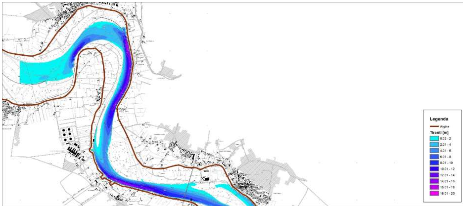
Figura 47 – risultati modello idraulico bidimensionale a fondo fisso – stato attuale – portata magra – tirante idrico – 1 di 4 (scala 1:50'000)
