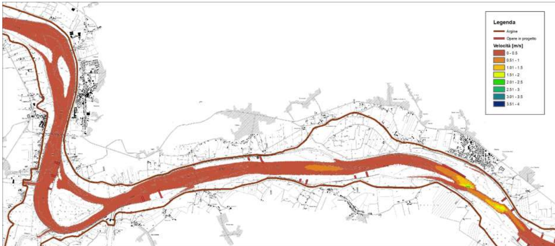
Figura 125 – risultati modello idraulico bidimensionale a fondo fisso – assetto di progetto – portata in secca – velocità della corrente – 3 di 4 (scala 1:50'000)
