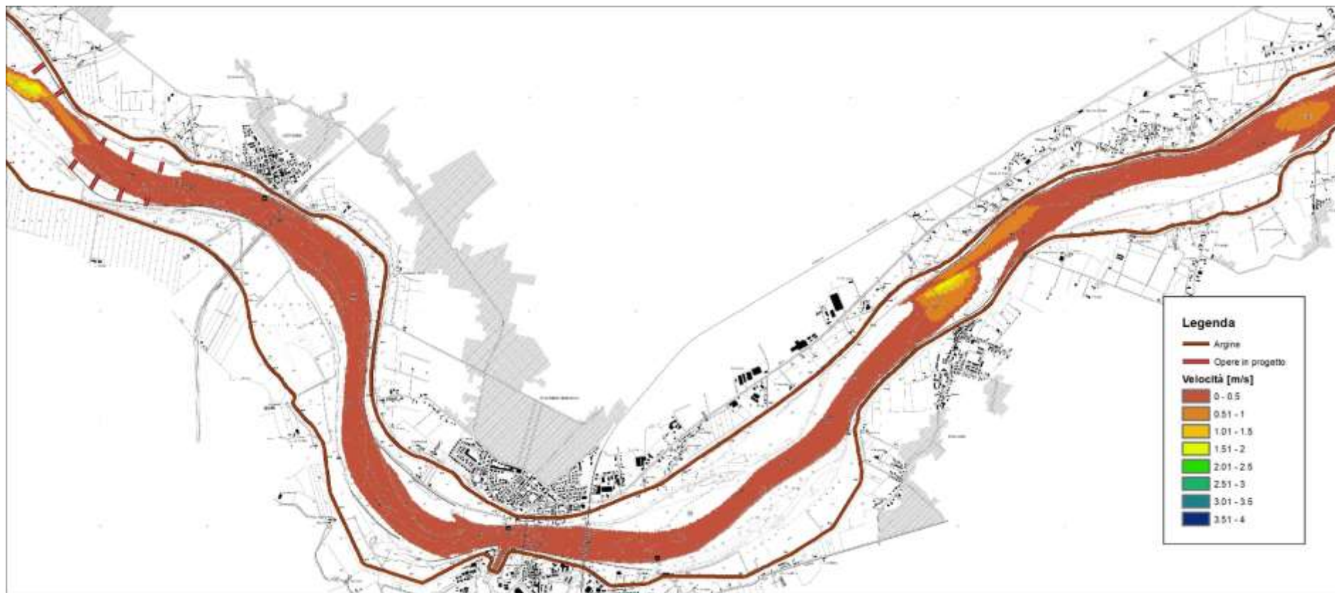
Figura 126 – risultati modello idraulico bidimensionale a fondo fisso – assetto di progetto – portata in secca – velocità della corrente – 4 di 4 (scala 1:50'000)
