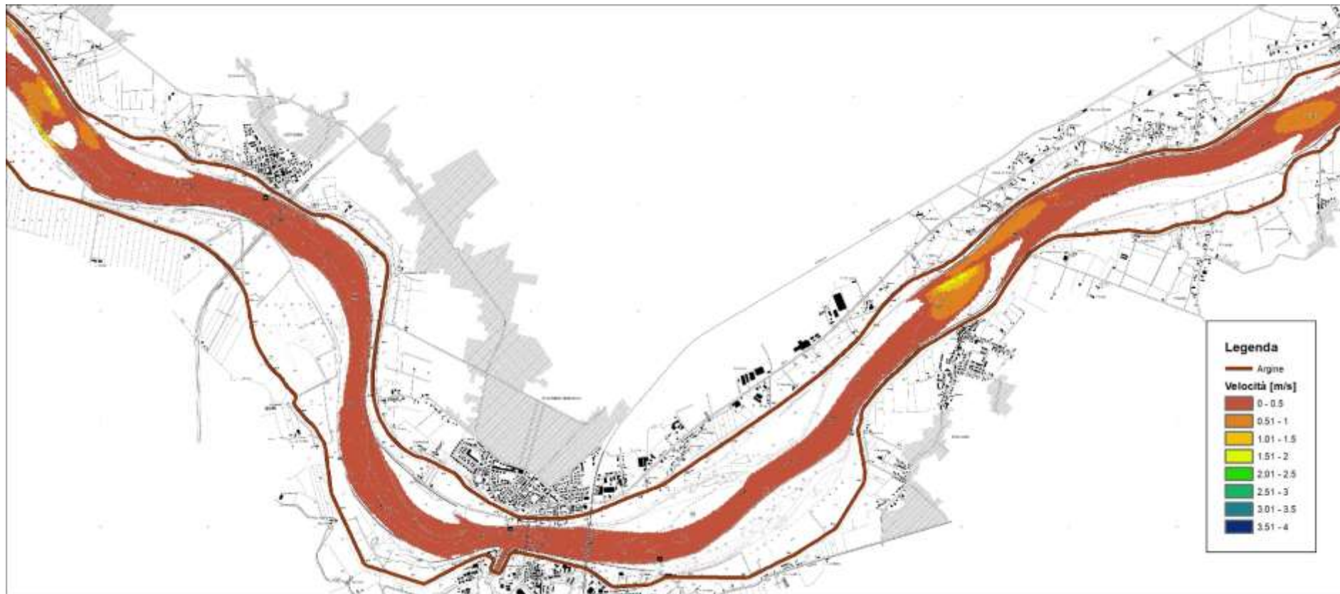
Figura 66 – risultati modello idraulico bidimensionale a fondo fisso – stato attuale – portata in secca – velocità della corrente – 4 di 4 (scala 1:50'000)
