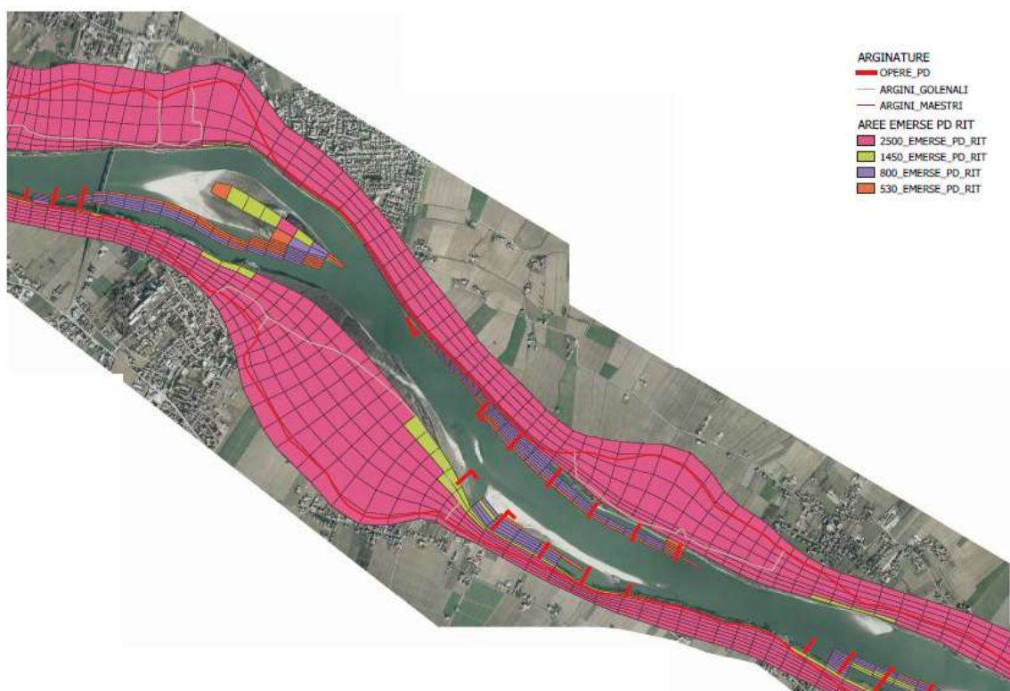
Figura 9. Esempio dell'output del modello applicato per il calcolo delle superfici interessate dall'emersione o sommersione al variare delle portate modellate (si tratta del segmento fluviale posto nei pressi di Castelmassa).
