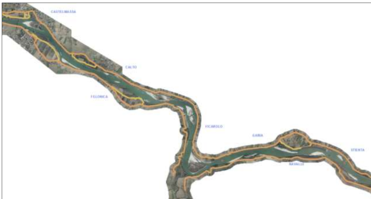
Tratto di Po interessato dalle opere di sistemazione con l'evidenziazione delle arginature maestre e golenali
