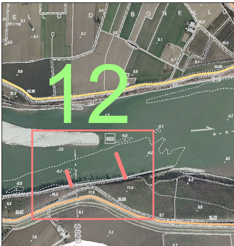
Figura 53: pennelli in destra idraulica in corrispondenza di Ravalle
