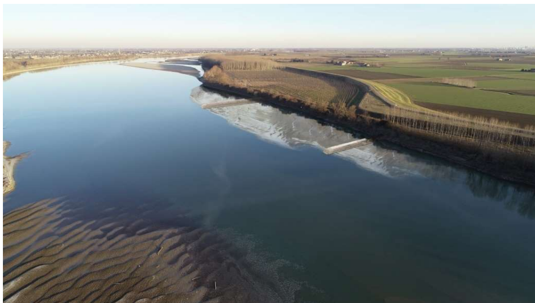
Figura 47: simulazione degli effetti indotti dalla realizzazione dei pennelli fluviali
