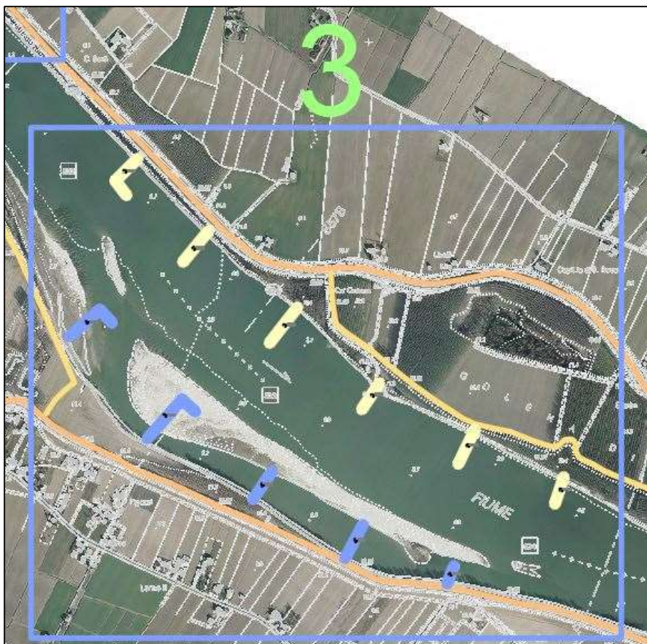
Figura 51: pennelli in destra idraulica in corrispondenza di Caposotto
