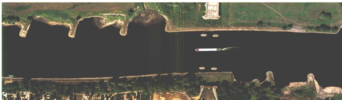
Figura 28 – Esempi di pennelli trasversali per la sistemazione a corrente libera del fiume Elba vicino a Magdeburgo.
