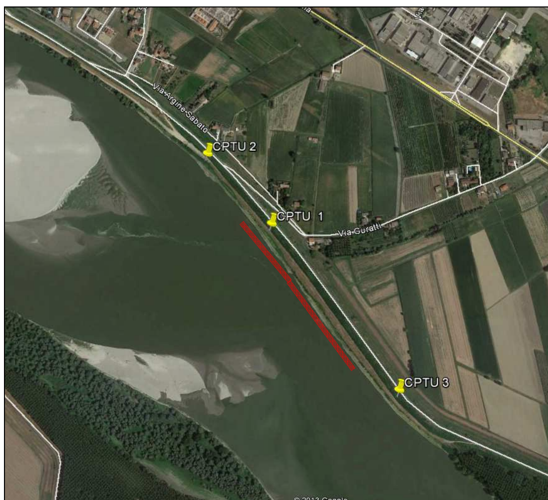
Figura 10 - ortofoto della zona d'intervento (evidenziata in rosso) – ubicazione delle 3 prove penetrometriche effettuate (luglio-settembre 2012)
