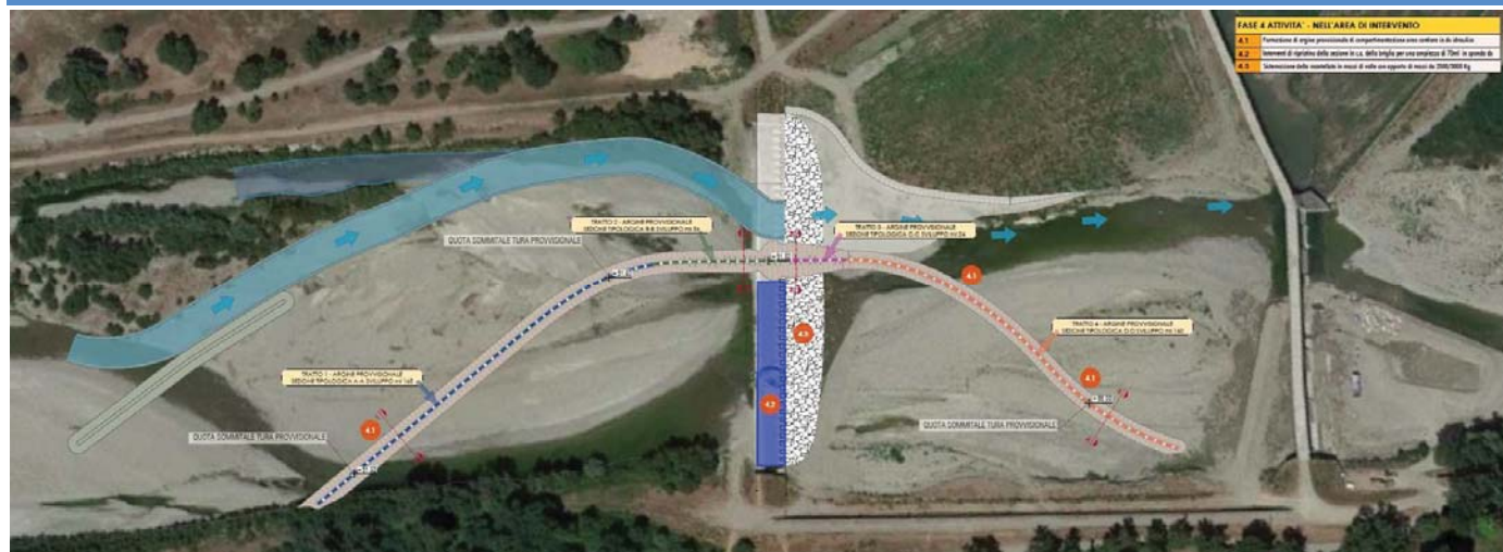
Figura 12 – Stagione 1 : Realizzazione di argine provvisoriale in destra idraulica per delimitazione area di cantiere
