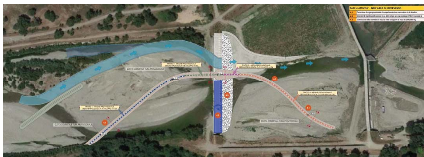
Figura 12 – Planimetria con realizzazione di argine provvisoria in destra idraulica per delimitazione area di cantiere
