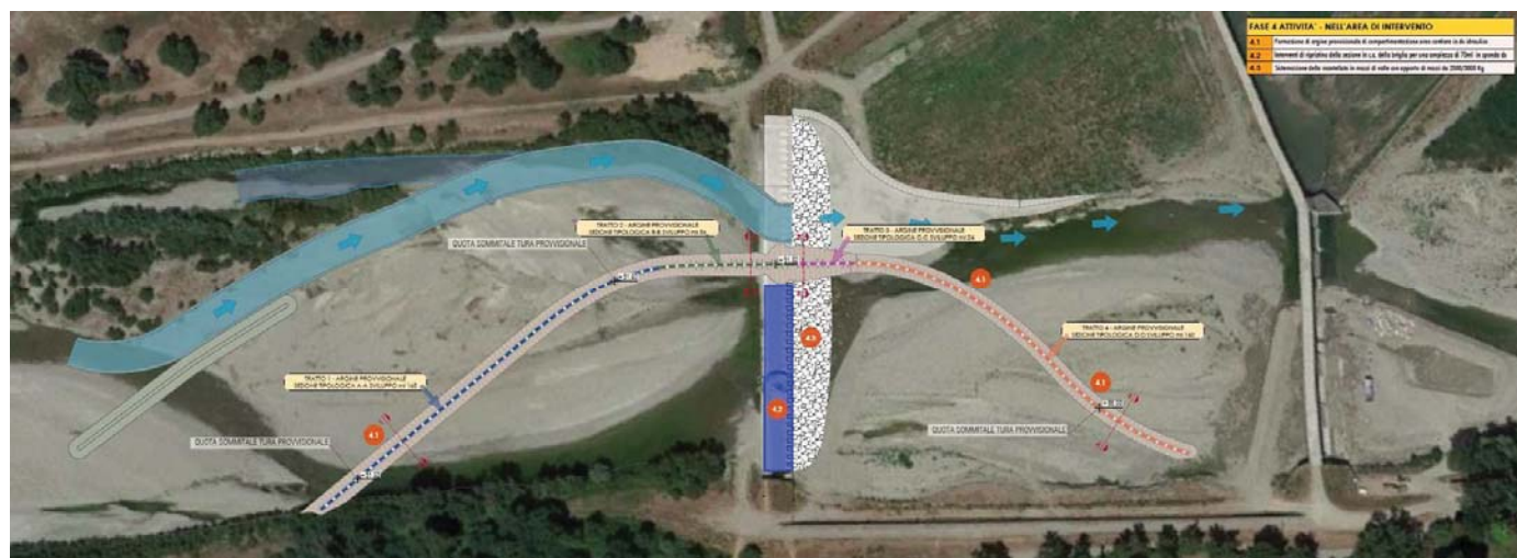
Figura 17 – Planimetria con realizzazione di argine provvisorio in destra idraulica per delimitazione area di cantiere
