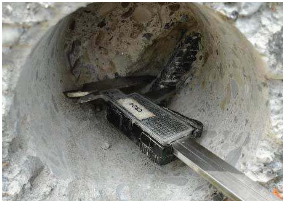
Foto 43. Manufatto limitatore di Valle. Spalla sinistra. Misura, mediante calibro digitale, diametro corrente. Precedentemente è stato misurato il copriferro reale.
