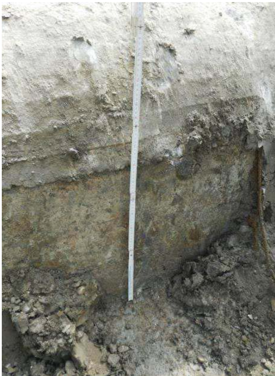
Foto 54. Traversa di Monte. Saggio in fondazione sponda destra
