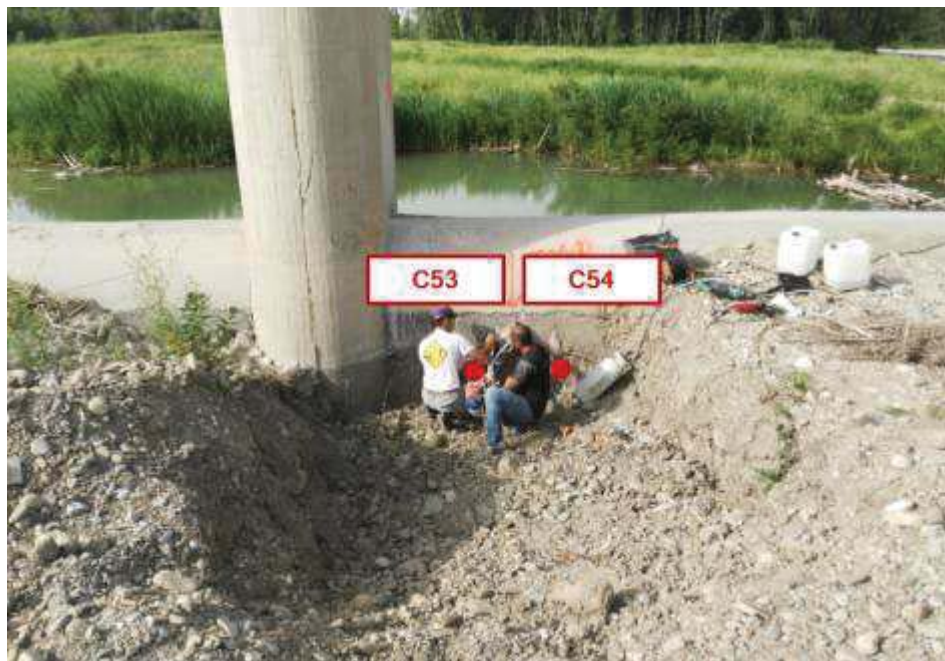
Foto 20. Manufatto limitatore di Monte. Esecuzione prelievi carote in fondazione
