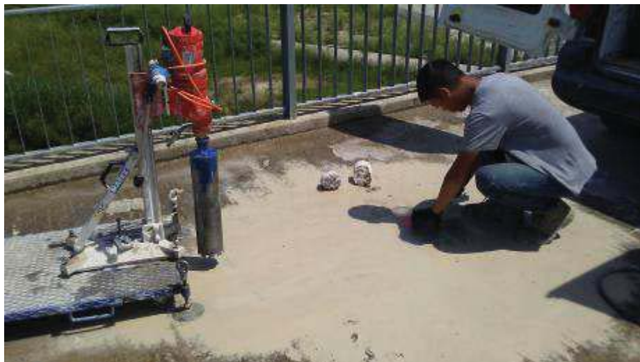
Foto 32. Manufatto limitatore di Monte. Esecuzione carotaggi sull'impalcato
