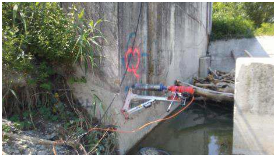
Foto 29. Traversa di Monte. Esecuzione carotaggi spalla destra
