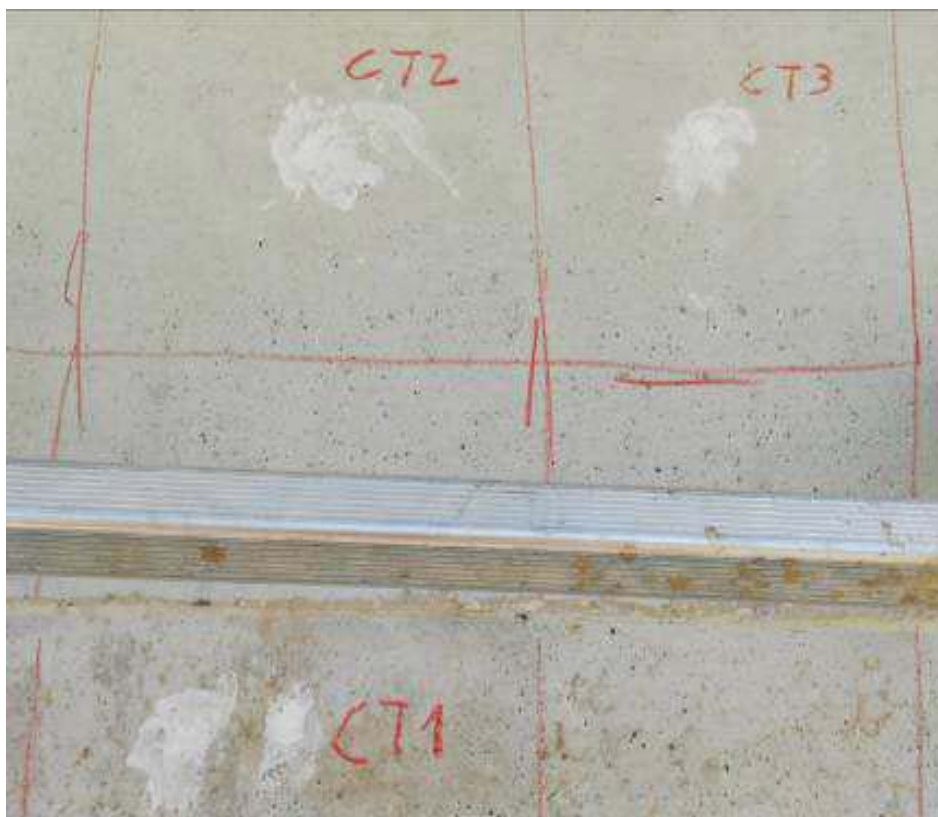
Foto 45. Manufatto limitatore di Monte. Sfioro di ingresso cassa. Trave C.A.P. con evidenziati in rosso i punti di prova. Fase di chiusura dei fori
