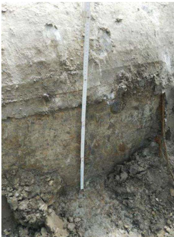
Figura 8: Saggio in fondazione sponda destra
