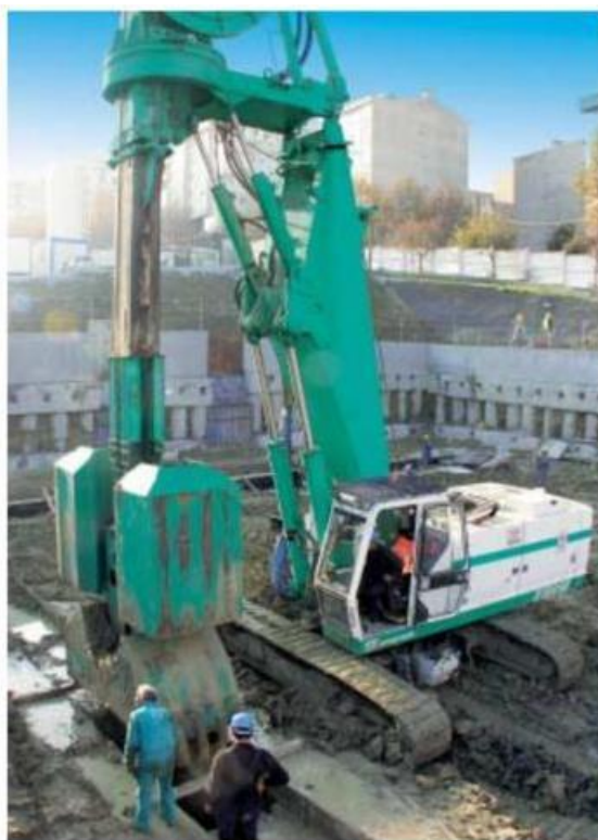
Figura 12 – Perforatrice cingolata tipo Casagrande B180HD
