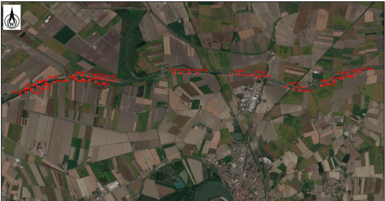
Fig. 4.1: Ubicazione dei n. 39 sondaggi con escavatore meccanico eseguiti in data 23-24/08/2021
