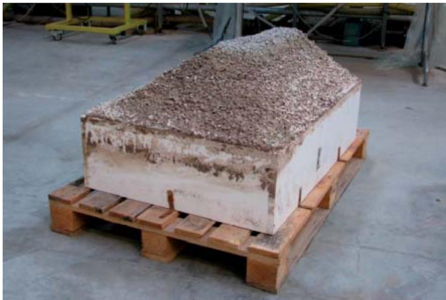
Figura 7 - Vista frontale di un pannello con fondazione rigida
