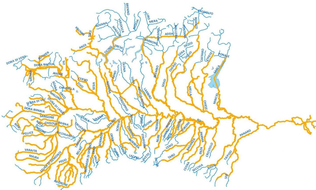
Figura 3: Schema indicativo dell'estensione del reticolo idraulico attualmente implementato nel modello Mike 11.
