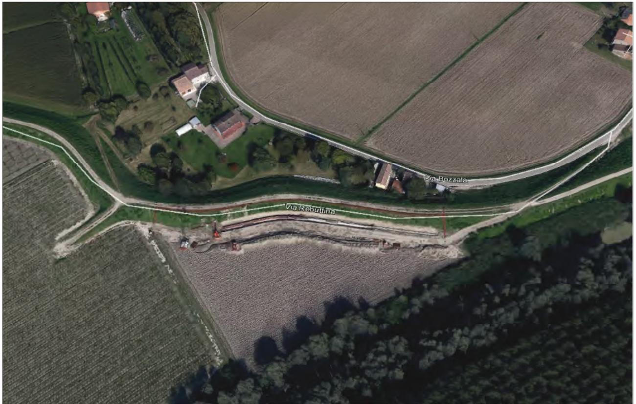
**Fig. 29 Inserimento di palancole al piede del rilevato arginale in via Rebutina stante 165-166**
