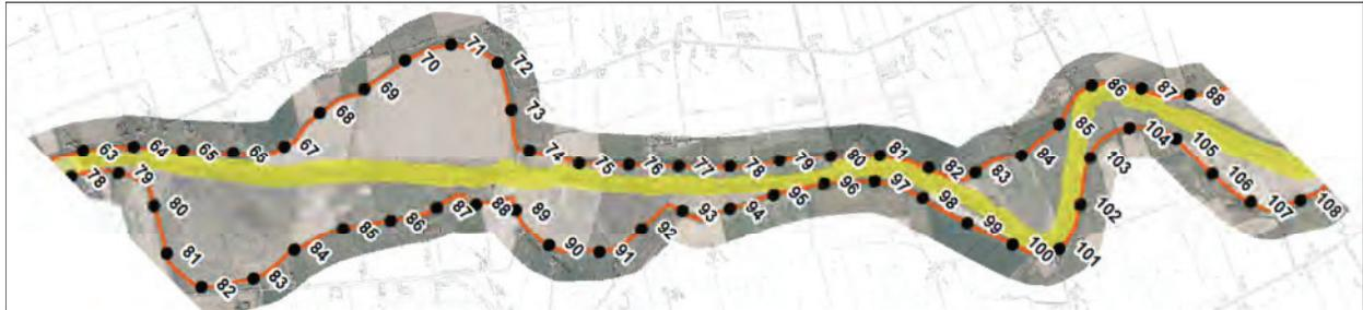
**Fig. 6** Esempio di delimitazione della Fascia di Dinamica Morfologica (FDM)
