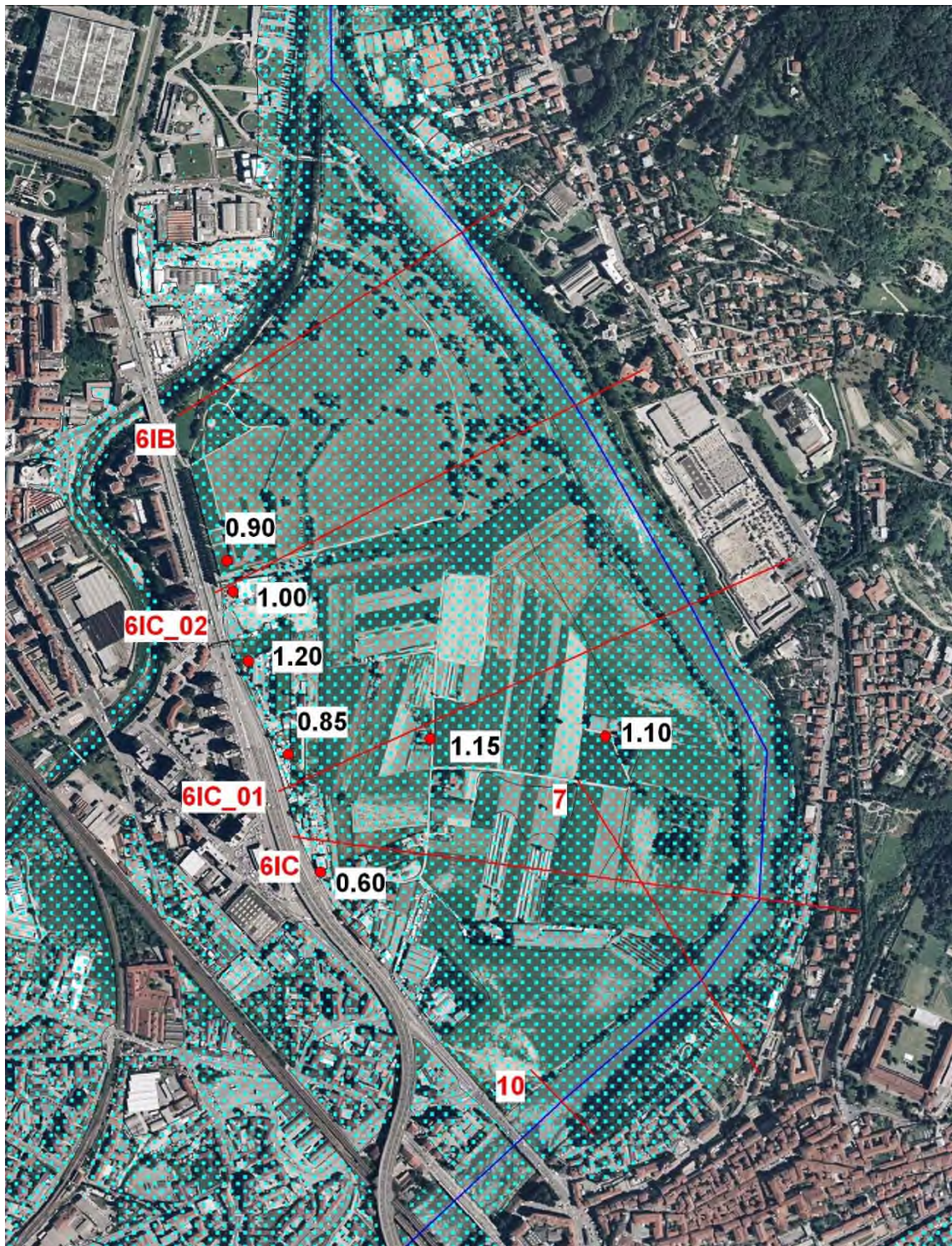
Fig. 3 Planimetria del tratto di interesse con indicazione dell'area allagata durante l'evento 2000, l'ubicazione dei punti di misura dei livelli idrici e i valori registrati
