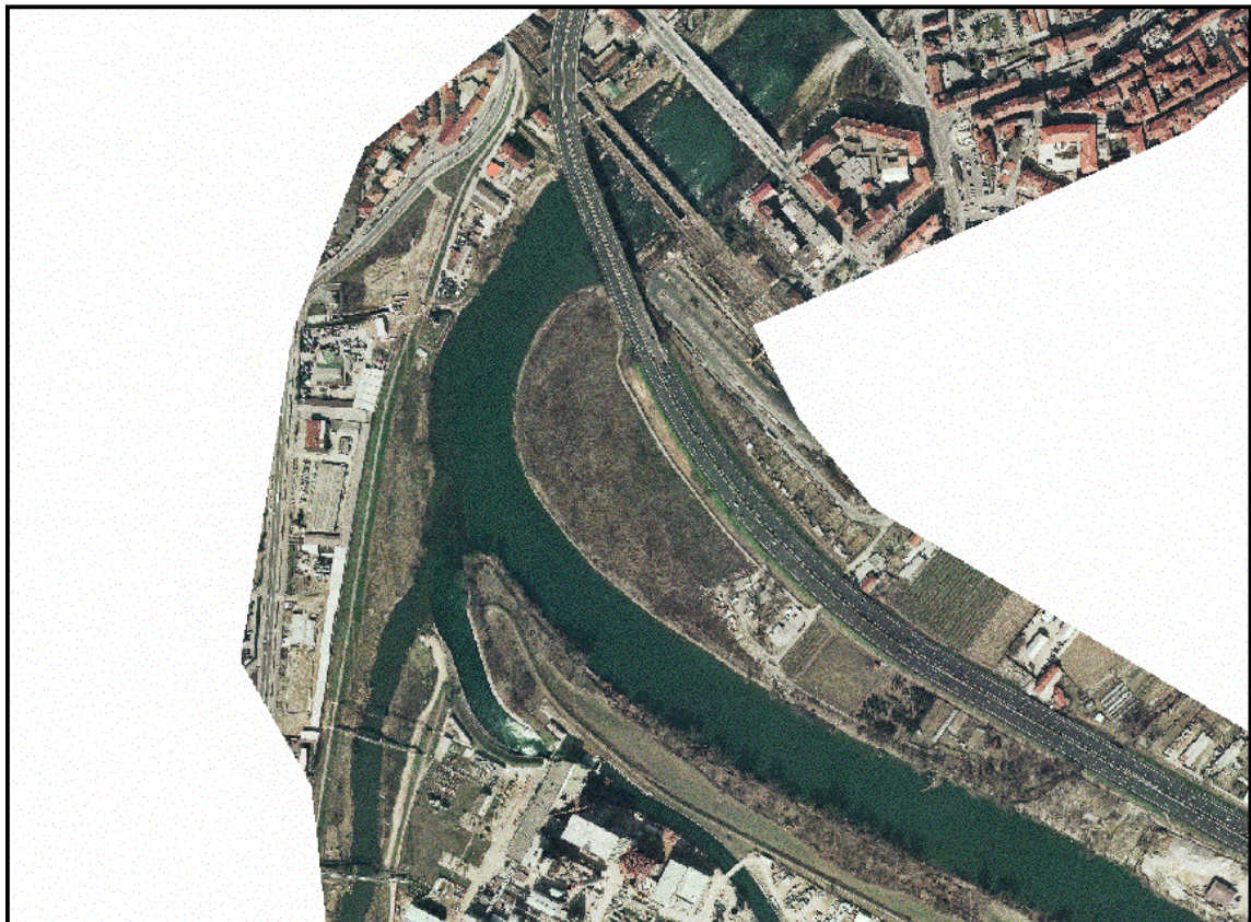
Figura 3 - Confluenza tra il f. Po ed il t. Chisola. Si noti l'ampia zona di sovralluvionamento in sponda destra che determina la parziale occlusione del ponte autostradale
