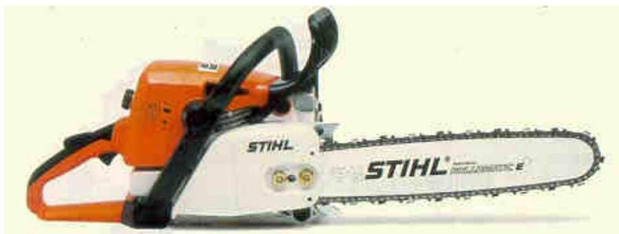
La **motosega**, sia di piccole che di grandi dimensioni (da rifinitura) rappresenta lo strumento da taglio molto importante. E' costituita da un motore a scoppio con accensione manuale e da un braccio portacatena (spranga) di diversa lunghezza; una frizione centrifuga si disinnesta automaticamente quando il motore funziona al minimo.
