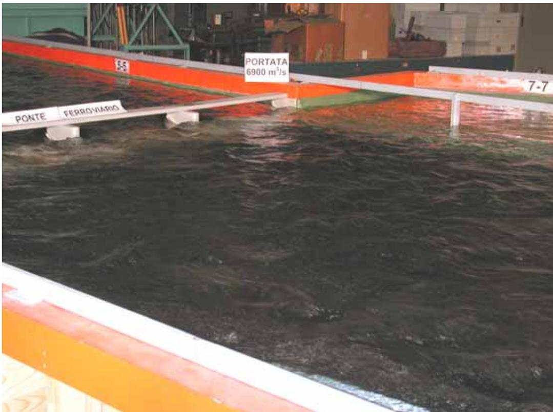
**Foto35:** Portata  $Q_{500}=6900 \text{ m}^3/\text{s}$  – Vista sez. 5 e 7 in sinistra idrografica.
