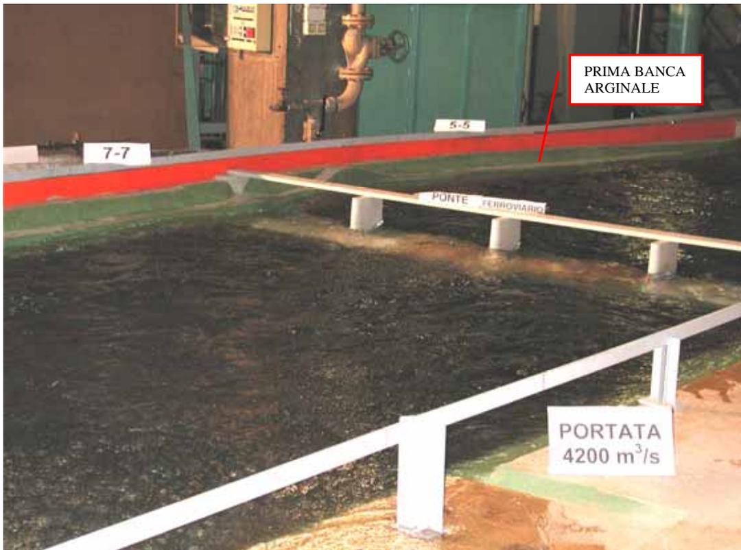
Foto18: Portata  $Q_{20}=4200 \text{ m}^3/\text{s}$  – Vista sez. 5-5 e 7-7 in destra idrografica.
