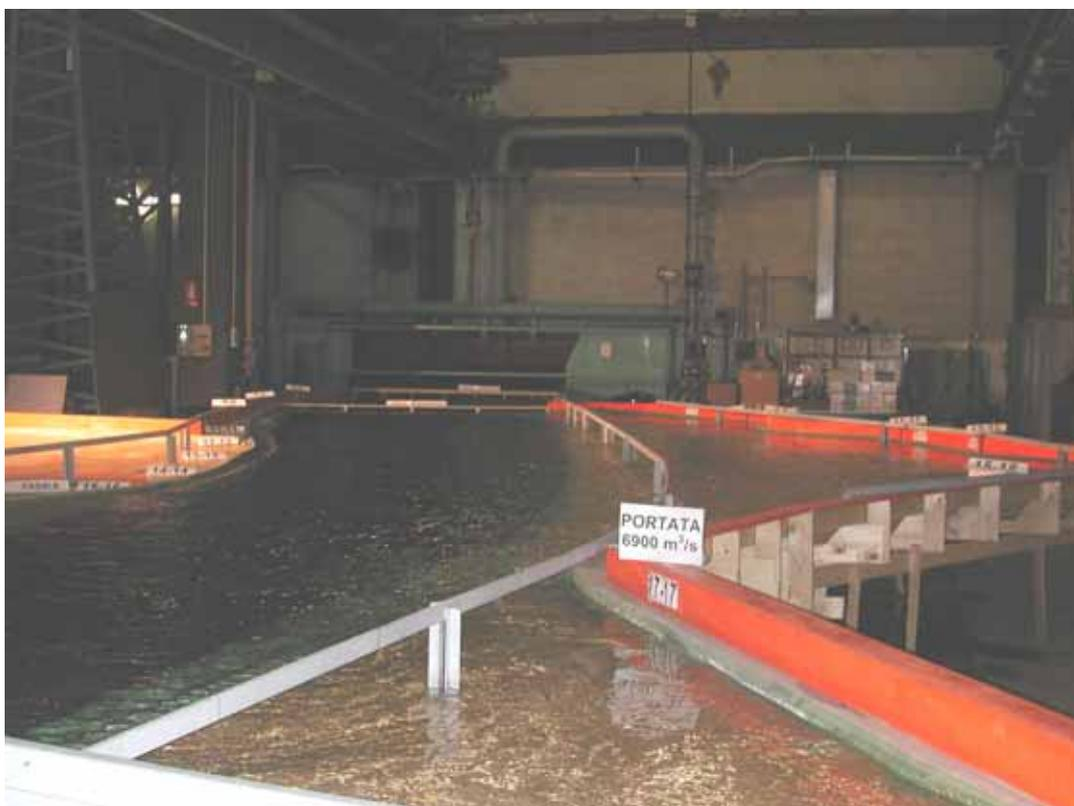
**Foto32:** Portata  $Q_{500}=6900 \text{ m}^3/\text{s}$  – Vista d'insieme.
