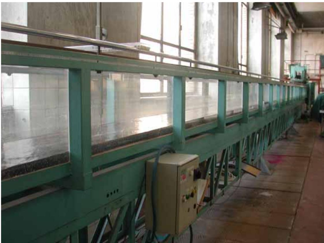
**Foto 5:** Canaletta utilizzata per determinare la scabrezza del fondo da assegnare al modello.
