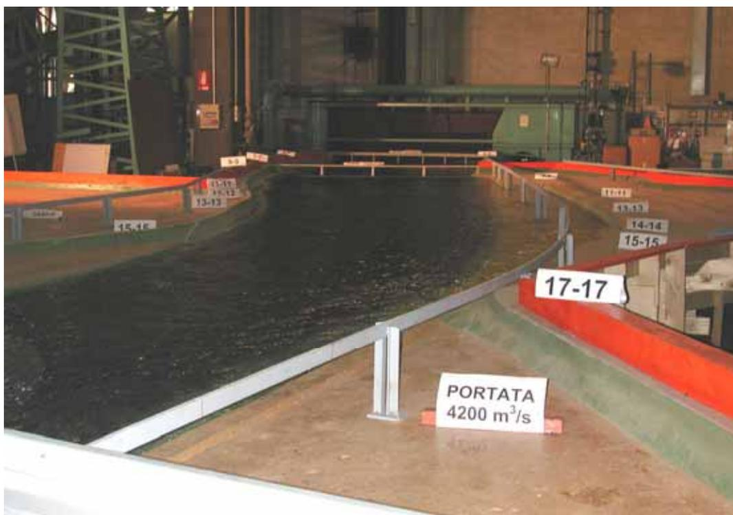
**Foto 17:** Portata  $Q_{20}=4200 \text{ m}^3/\text{s}$  – Vista d'insieme.
