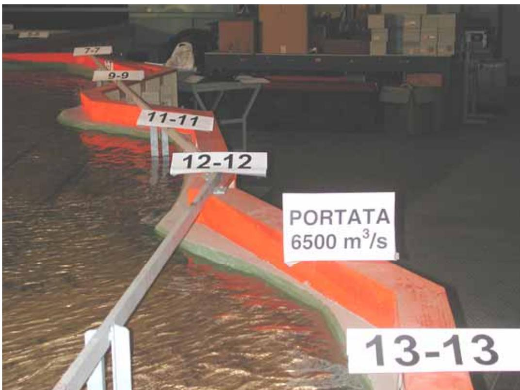
Foto31: Portata  $Q_{200}=6100 \text{ m}^3/\text{s}$  – Sezioni 9 – 13 in sinistra orografica.
