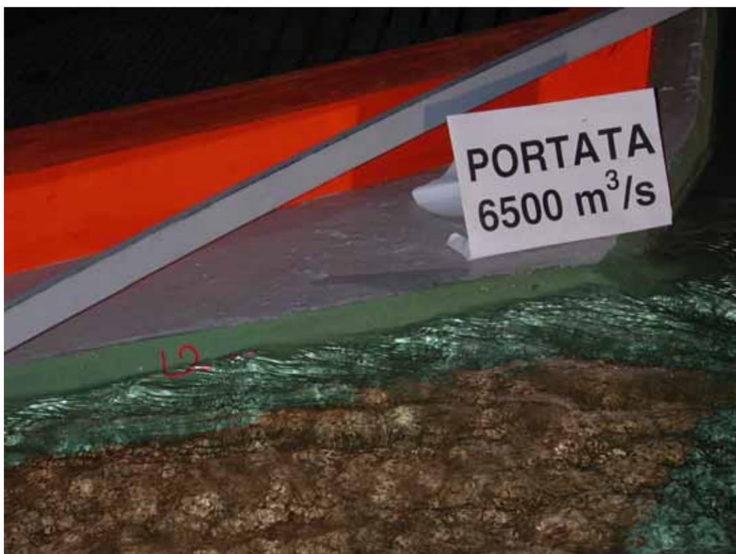
Foto 10: Portata  $Q_{1994}=6500 \text{ m}^3/\text{s}$  – Livello L2. (rif. utilizzato per la taratura).
