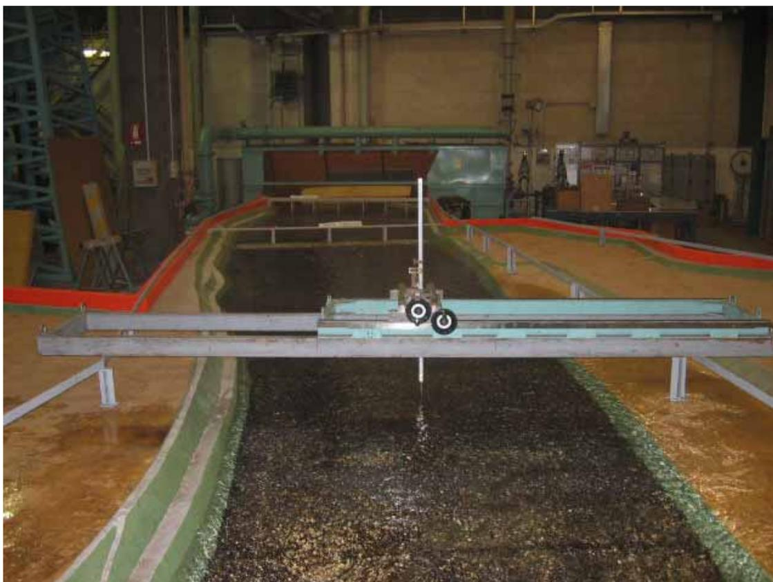
**Foto 6:** Apparato per la misura dei livelli idrometrici. Sono visibili i profilati di appoggio orizzontali, la trave di supporto, il coordinatometro e l'asta idrometrica.
