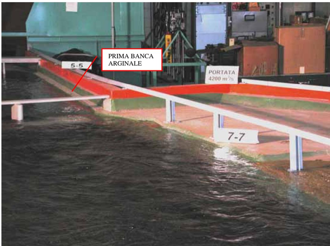
Foto19: Portata  $Q_{20}=4200 \text{ m}^3/\text{s}$  – Vista sez. 5-5 e 7-7 in sinistra idrografica.
