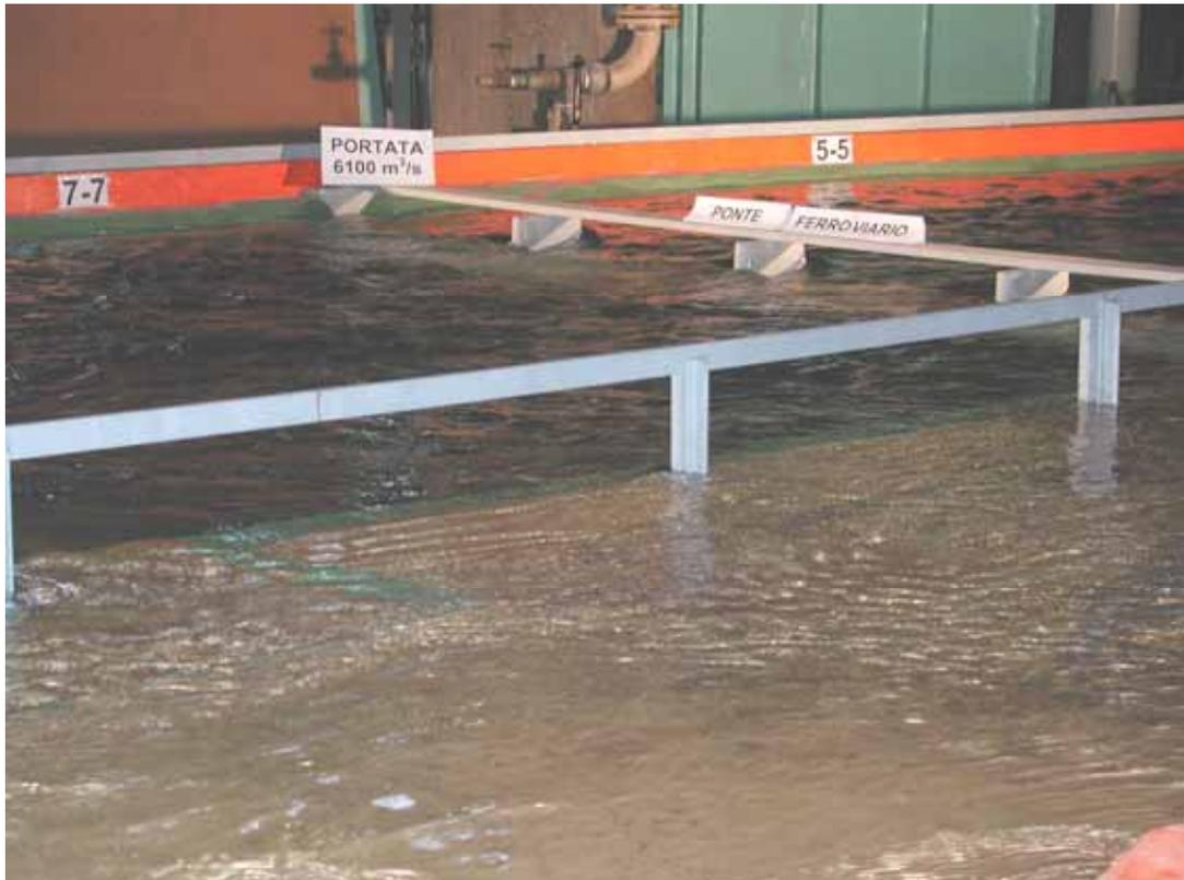
Foto28: Portata  $Q_{200}=6100 \text{ m}^3/\text{s}$  – Sezioni 5 – 7 in destra orografica.
