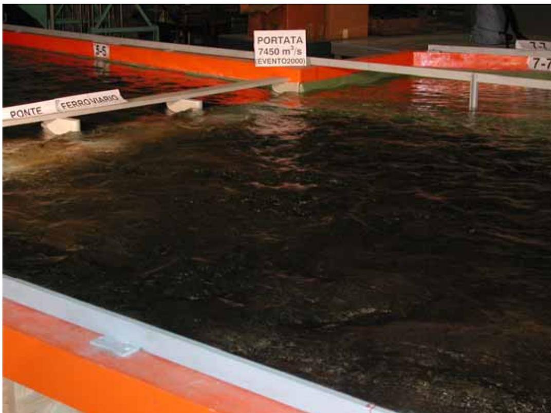
**Figura 46:** Portata  $Q_{2000}=7450\text{m}^3/\text{s}$  – Sezioni 5 – 7 in sinistra orografica.
