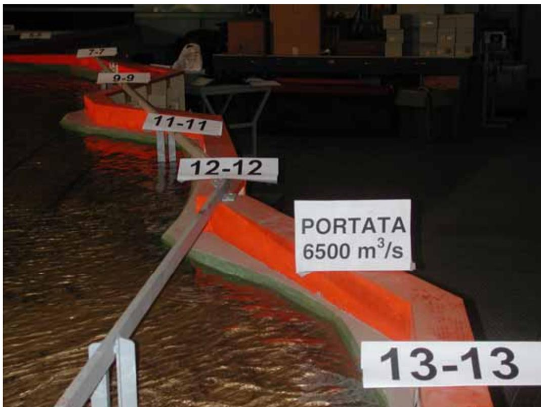
Foto 15: Portata  $Q_{1994}=6500\text{m}^3/\text{s}$  – Sezioni 7 – 13 in sinistra idrografica.
