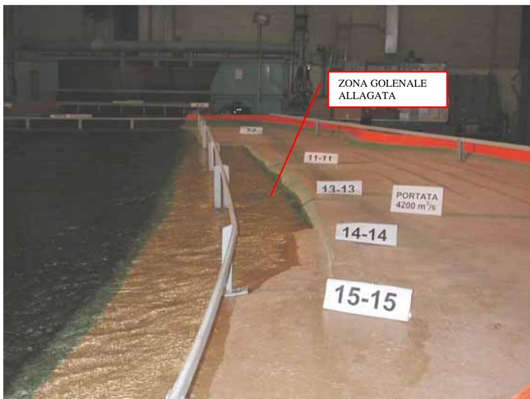
Foto 21: Portata  $Q_{20}=4200 \text{ m}^3/\text{s}$  – Vista sez. 11-11 – 15-15 in sinistra idrografica.
