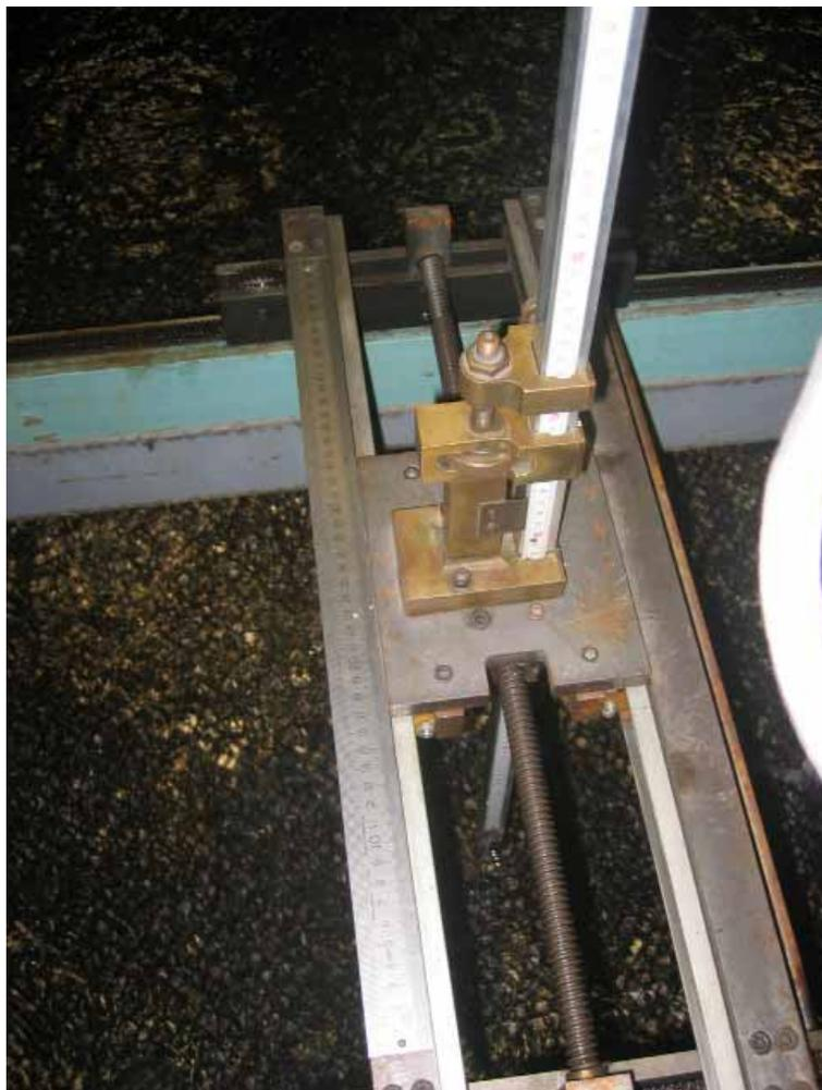
**Foto 7:** Particolare del coordinatometro e dell'asta idrometrica utilizzata per la misura dei livelli idrometrici.
