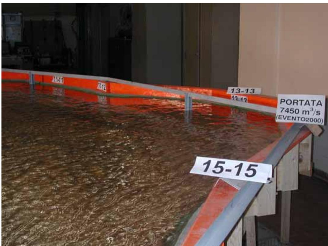
**Figura 47:** Portata  $Q_{2000}=7450\text{m}^3/\text{s}$  – Sezioni 11 – 15 in sinistra orografica.
