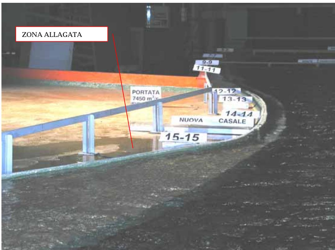
Figura 40: Portata  $Q_{2000}=7450 \text{ m}^3/\text{s}$  – Sezioni 11 – 15 in destra orografica.
