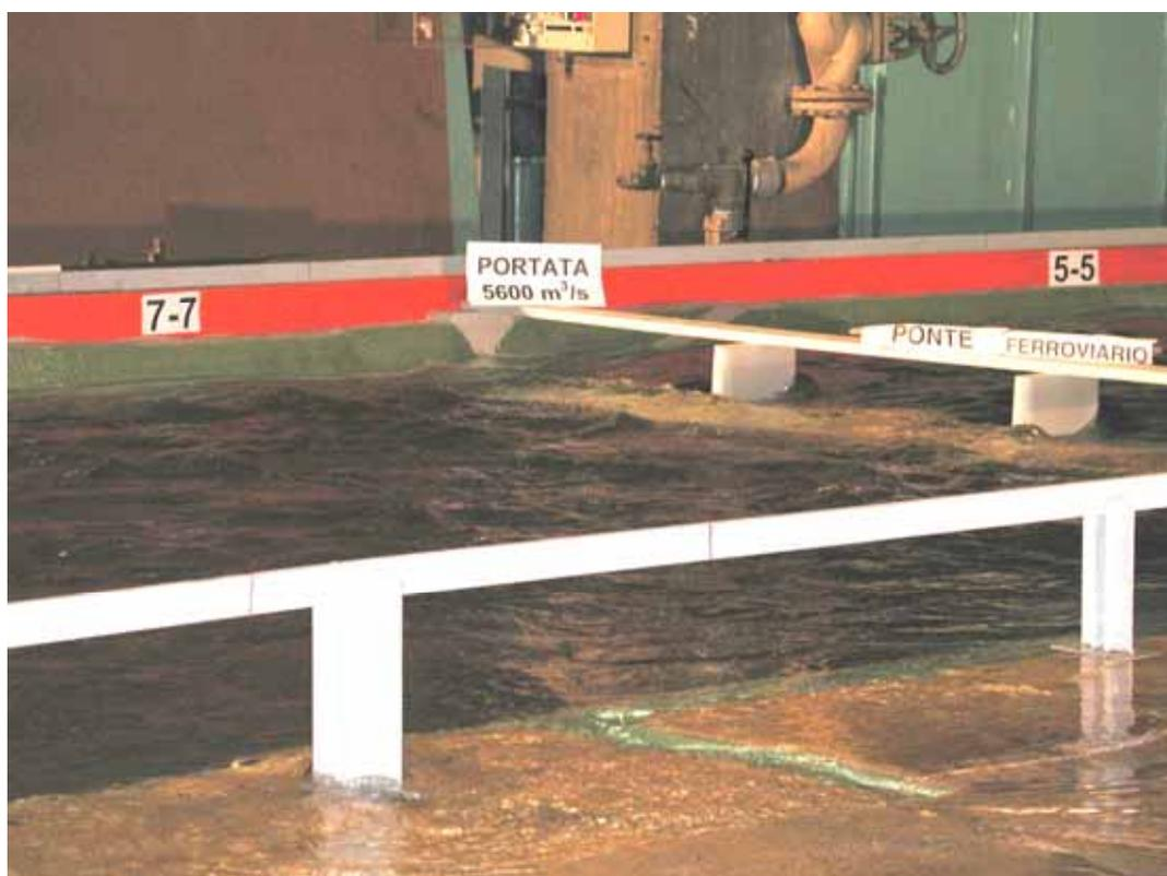
**Foto23:** Portata  $Q_{100}=5600 \text{ m}^3/\text{s}$  – Sezioni 5 – 7 in destra orografica.
