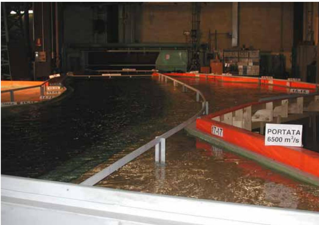
**Foto 8:** Portata  $Q_{1994}=6500 \text{ m}^3/\text{s}$  – Vista d'insieme.
