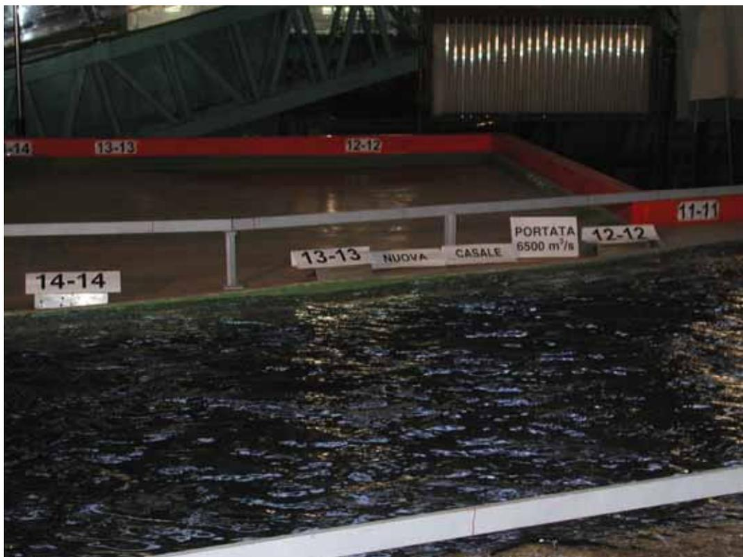
Foto 12: Portata  $Q_{1994}=6500 \text{ m}^3/\text{s}$  - Sezioni 11 - 14 in destra idrografica.
