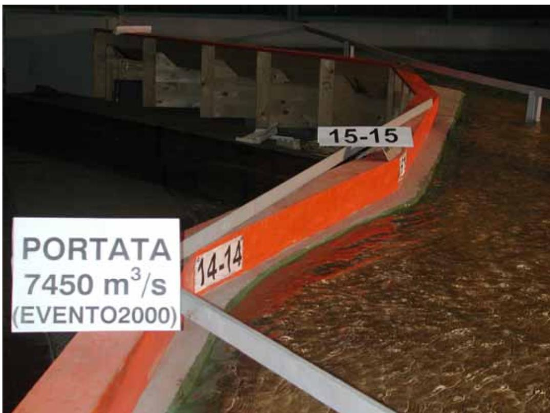
Figura 42: Portata  $Q_{2000}=7450\text{ m}^3/\text{s}$  – Sezioni 14 – 15 in sinistra orografica.
