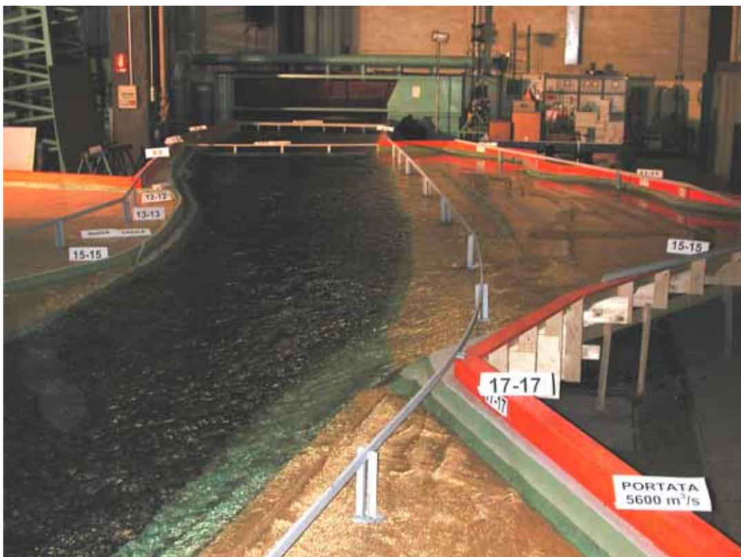
Foto22: Portata  $Q_{100}=5600 \text{ m}^3/\text{s}$  – Vista d'insieme.
