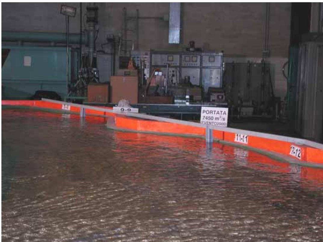
Figura 41: Portata  $Q_{2000}=7450\text{m}^3/\text{s}$  – Sezioni 7 – 12 in sinistra orografica.
