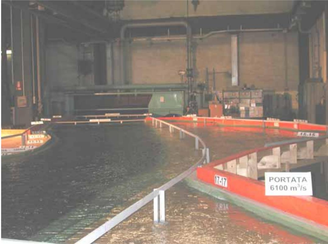
Foto 27: Portata  $Q_{200}=6100 \text{ m}^3/\text{s}$  – Vista d'insieme.
