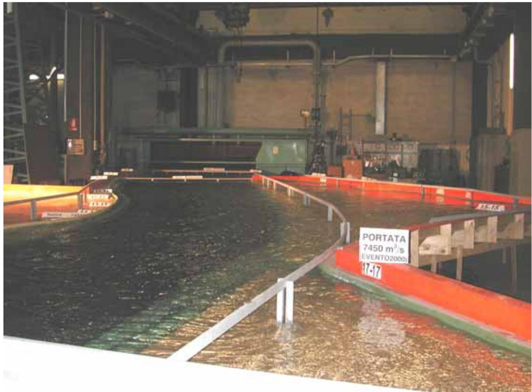
**Figura 43** : Portata  $Q_{2000}=7450 \text{ m}^3/\text{s}$  – Vista d'insieme.
