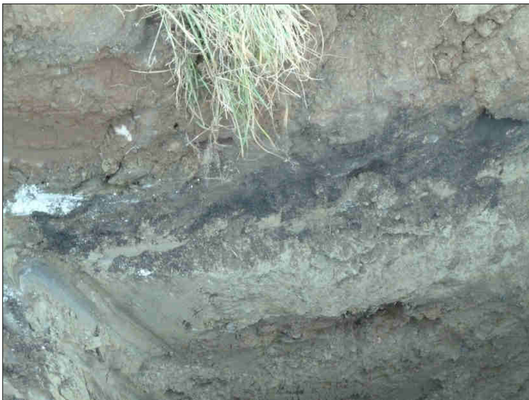
Foto 5 Pozzetto n. 4. Livello limoso-argilloso plastico con resti carboniosi nella parte superiore, seguito da un nuovo livello più ghiaioso "sporco".
