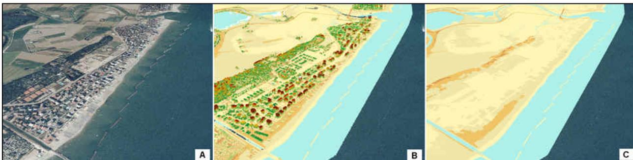
Figura B - 4. Esempio di rappresentazione 3D del tratto di costa a sud della Foce del Savio. A) Foto aerea, B) Modello Digitale di Superficie (DSM), C) Modello Digitale del Terreno (DTM).
