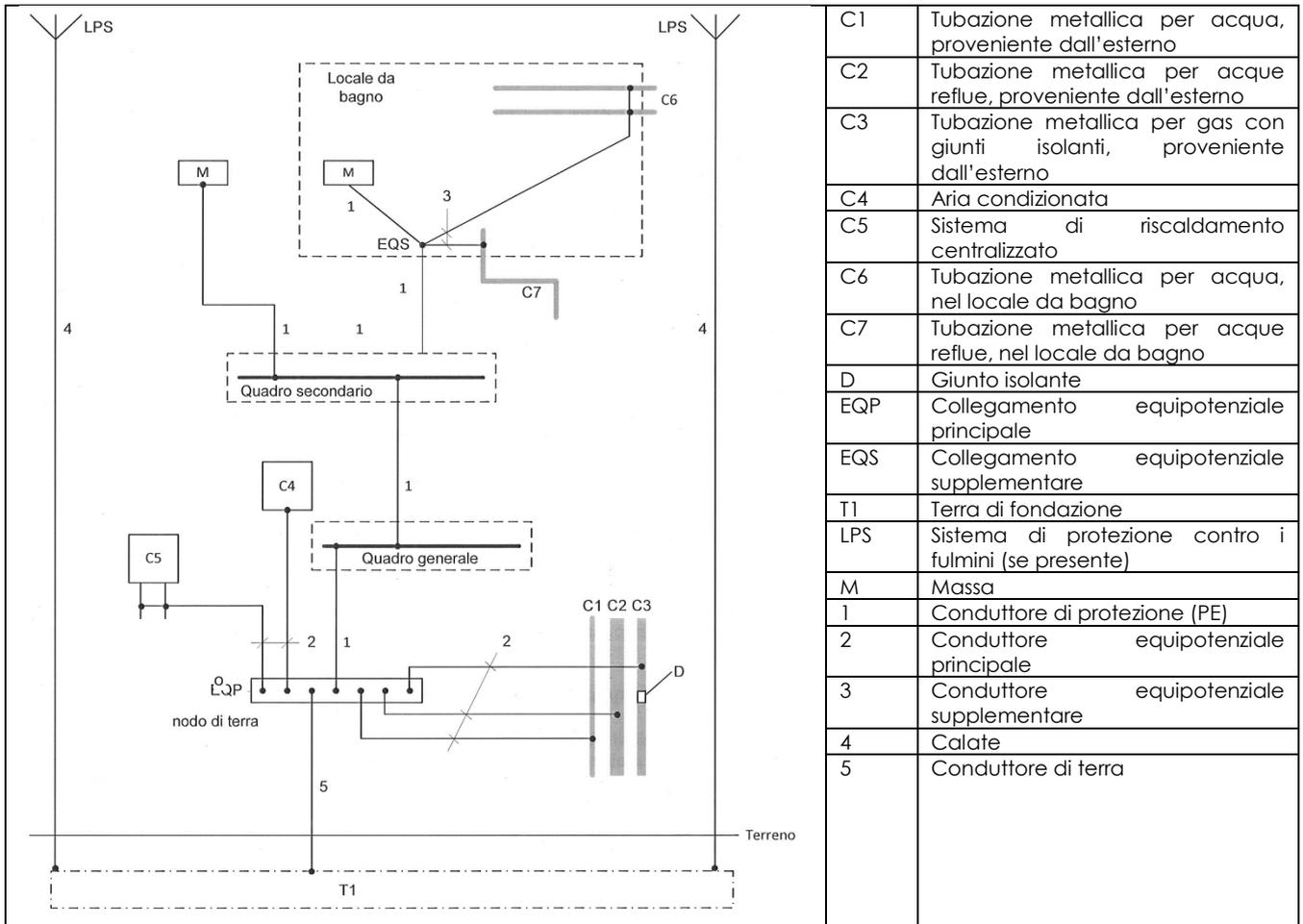
A seconda del tipo di messa a terra l'impianto utilizzatore viene classificato come TT, TN (TN-S / TN-C) o IT; la prima lettera indica lo stato del sistema rispetto al terreno (I = isolato, T = a terra), la seconda lo stato delle masse rispetto al terreno (T = a terra, N = al neutro). Nei sistemi TT il conduttore di neutro non può utilizzato come conduttore di protezione.
