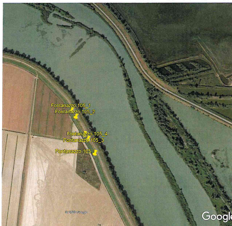
Figura 6 - Tratto E - Ubicazione delle criticità in destra idraulica del Po di Maistra – stanti 28-30 nel comune di Porto Tolle (RO) – in evidenza i fontanazzi (fonte Google Earth – f.s.)
