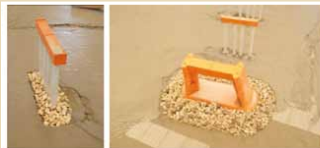
Fig. 16 – Effetto del rip-rap per Q200 sulla fondazione principale e sul quartetto pila n.5
