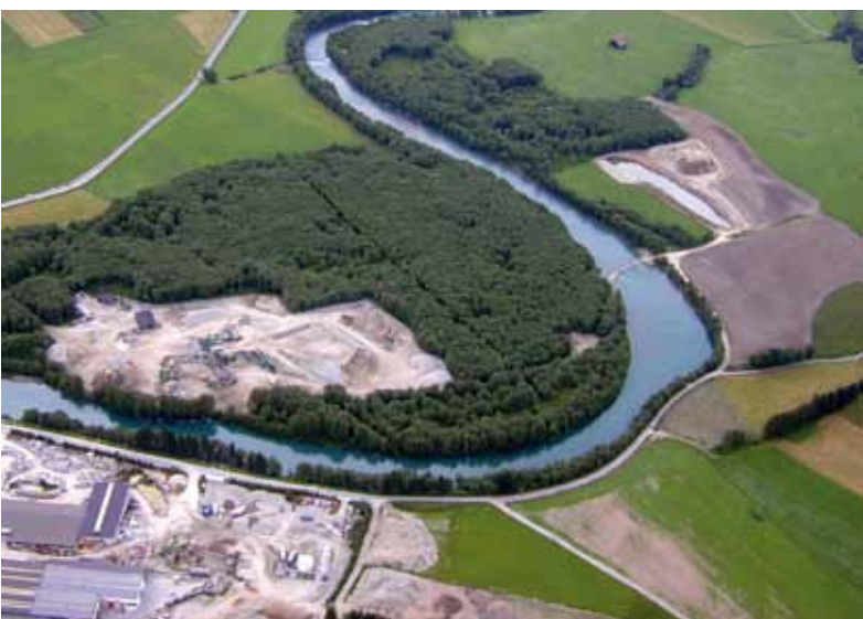
Esempio di intervento di riqualificazione morfologica (ampliamento della sezione, riattivazione di dinamiche fluviali, creazione di nuove forme fluviali) realizzato sul torrente Aurino presso Brunico (BZ). A sinistra la situazione pre-intervento a destra la situazione dopo la realizzazione dei lavori. Foto gentile concessione Provincia Autonoma di Bolzano – Ripartizione Opere Idrauliche.
